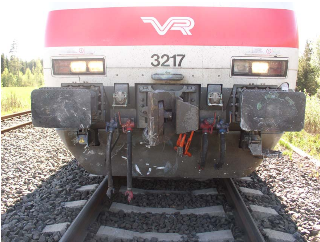
Kuva 3. Vaurioita veturin keulassa. Alhaalla karja-aurassa havaittavissa henkilöauton vasemman takarenkaan jättämä jälki. (kuva Poliisi)
