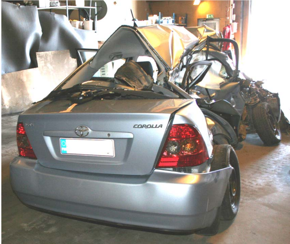
Kuva 3. Henkilöauto vaurioitui onnettomuudessa korjauskelvottomaksi. Auton oikea kylki painui sisään koko leveydeltään, syvin painuma oli 70 cm auton B-pilarin kohdalta.
