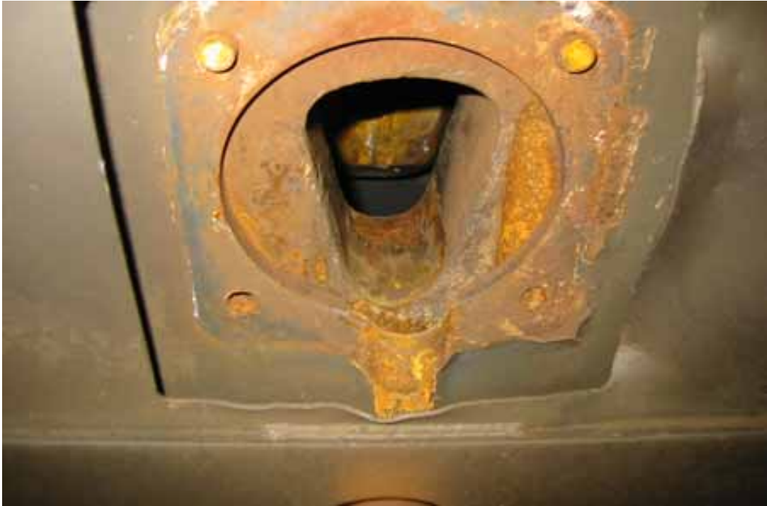
Kuva 7. Kuvassa näkyvät katkenneet ruuvit ja kiilan kuluttama ura vetolaitteen kotelon pohjaan.
