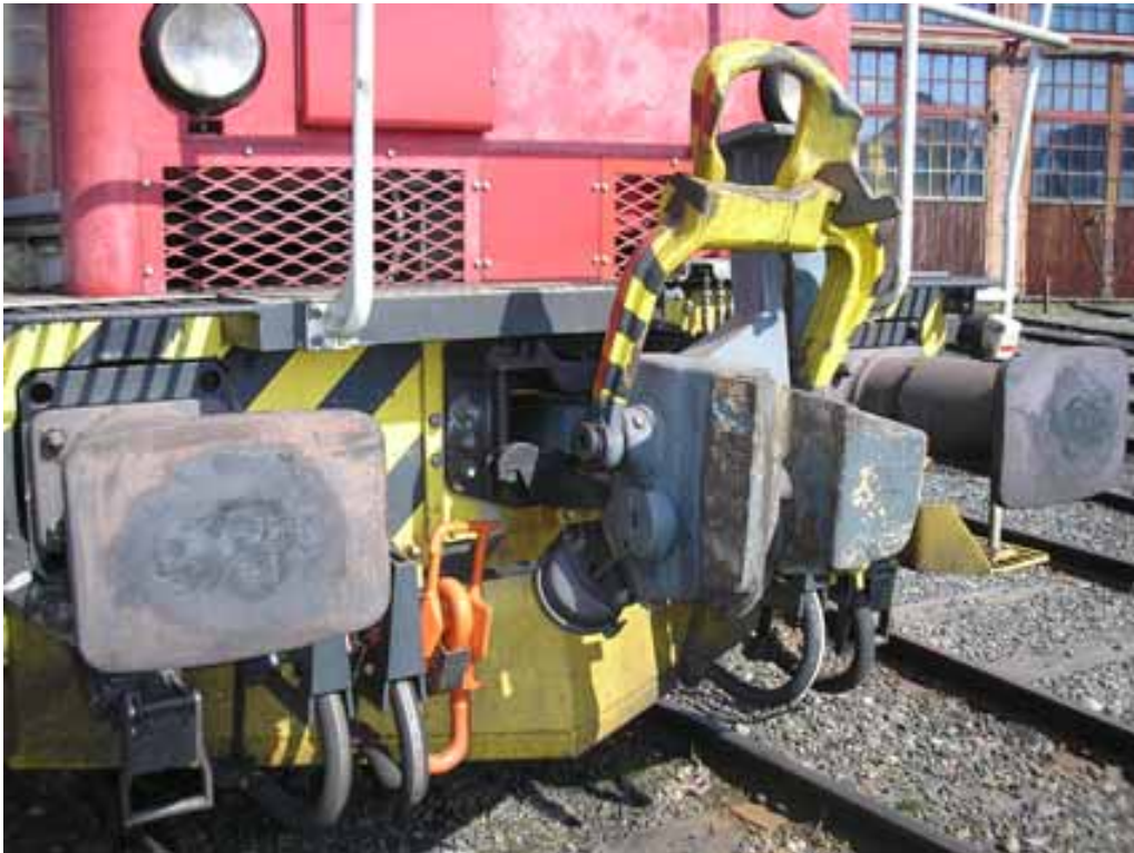
Kuva 3. Veturit oli kytketty yhteen kuvassa näkyvällä SA3-automaattikytkimellä.
