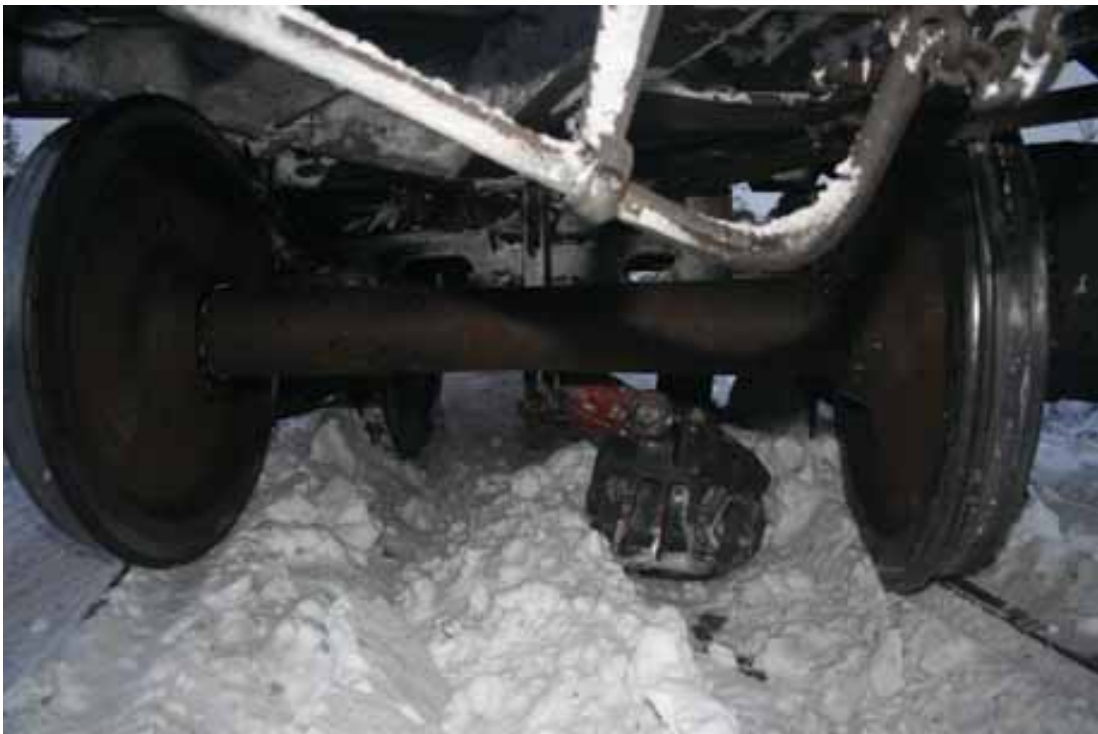
Kuva 2. Vetolaite tarttui vaunun takimmaisena telin alle ja suisti telin kiskoilta.
