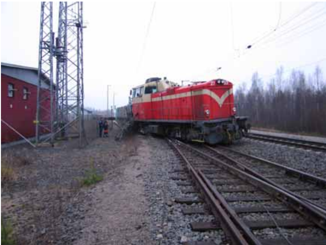
Kuva 2. Veturi törmäsi suistumisen jälkeen sähköratapylvääseen.
