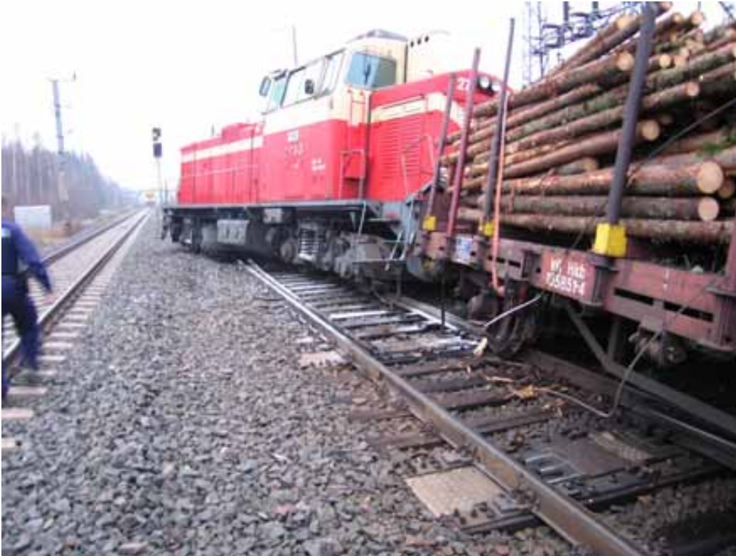
Kuva 3. Veturi kallistui suistumisen jälkeen voimakkaasti oikealle.
