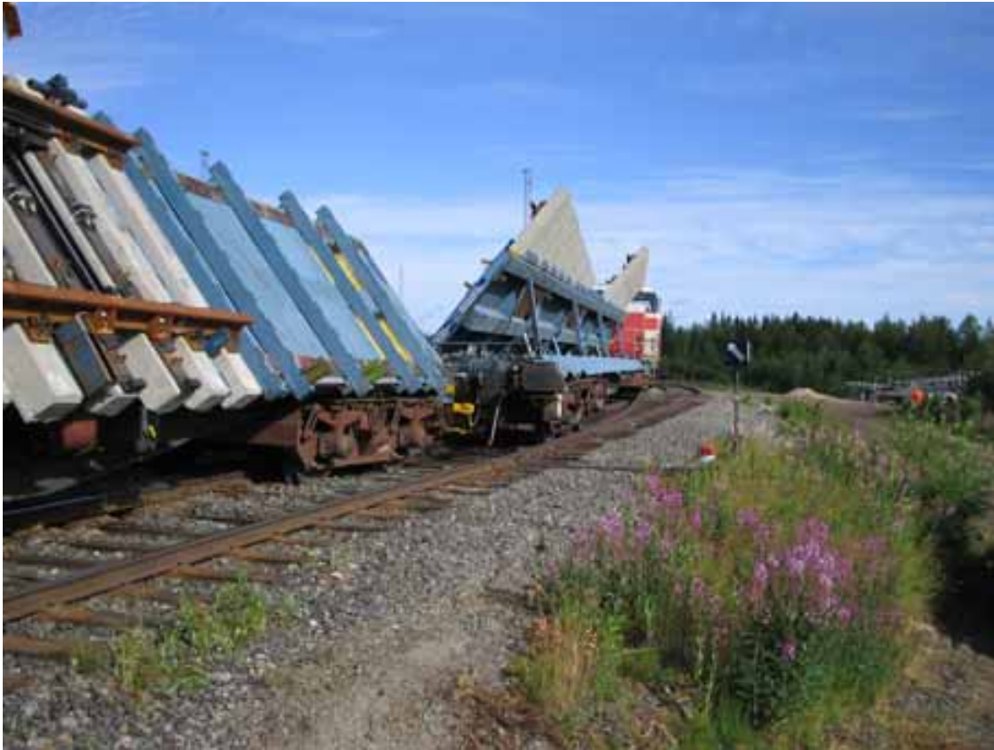
Kuva 2. Junan kahden ensimmäisen vaunun väli. Toisen vaunun etuteli ja ensimmäisen vaunun takatelin jälkimmäinen pyöräkerta ovat suistuneet.
