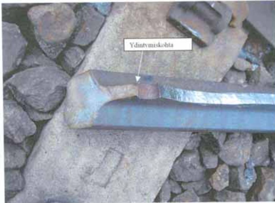
Kuva 5. Sekundäärimurtuman murtopinta. Murtuman ydintymiskohta on merkitty nuolella.
