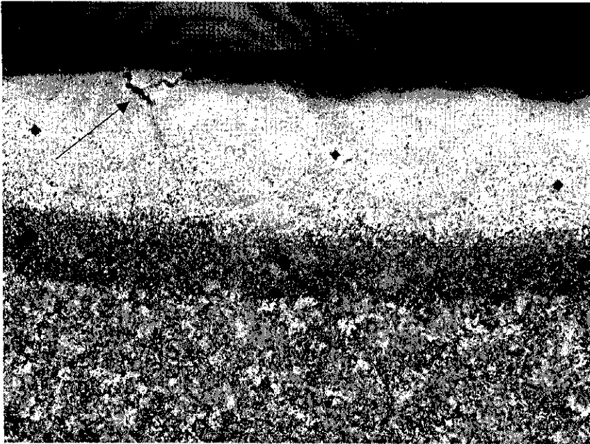
Kuva 18. Hitsiliitoksen mikrorakenne. Ylinnä karennut kerros (kovuus 670 HV1), keskellä tumma lämpövyöhyke (keskimääräinen kovuus 345 HV1) ja alhaalla perusaine (kovuus 300 HV1). Nuolella on osoitettu kareneeseen vyöhykkeeseen muodostunut särö. Suurennos 50X.
