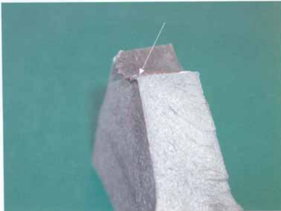
Kuva 8. Valokuva sidekiskoruuvien reiän purseesta. Ydintymiskohta merkitty nuolella.
