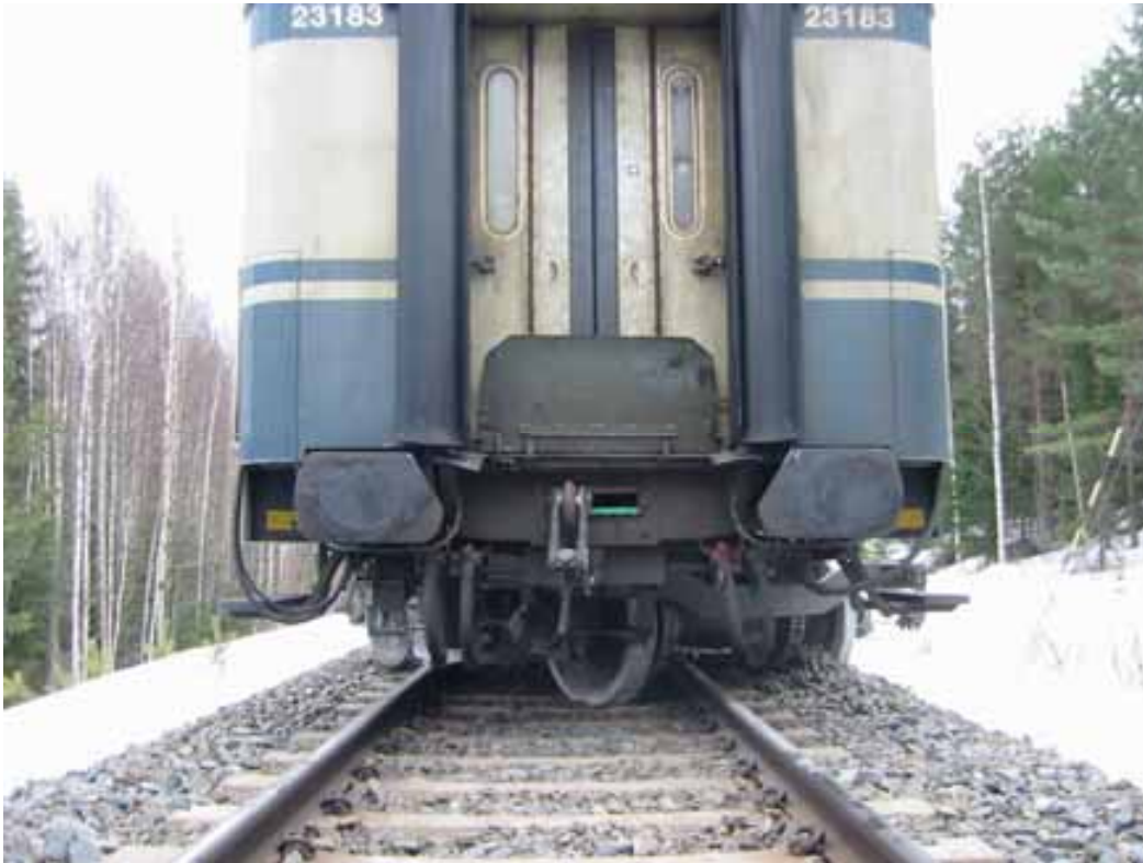
Kuva 4. Junan toiseksi viimeisen vaunun etupään teli suistui kiskoilta ja jäi 45 asteen kulmaan.
