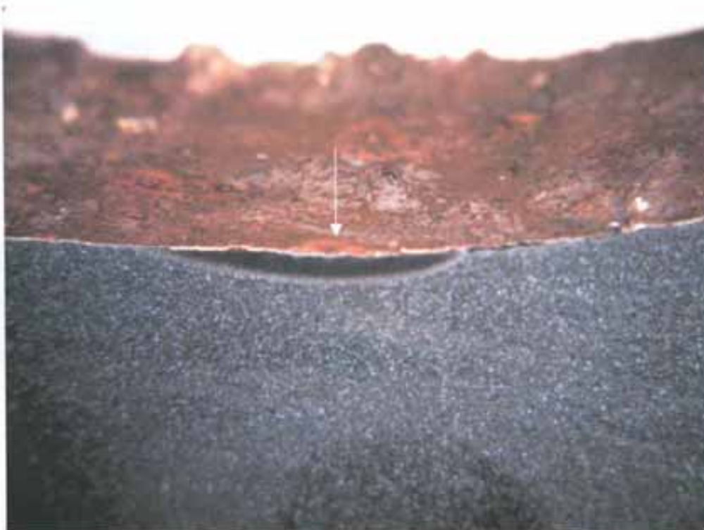
Kuva 17. Stereomikroskooppikuva hitsausliitoksen poikkileikkauspinnasta. Karennut alue näkyy tummana keskellä kuvaa (nuoli). Suurennos 8X.
