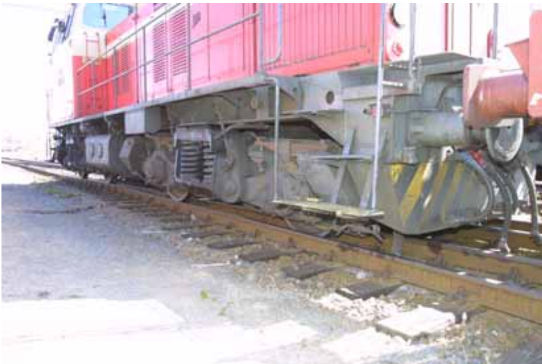
Kuva 2. Vaunua työnnettäessä veturin ensimmäinen pyöräkerta suistui kiskoilta kulkusuunnassa vasemmalle.
