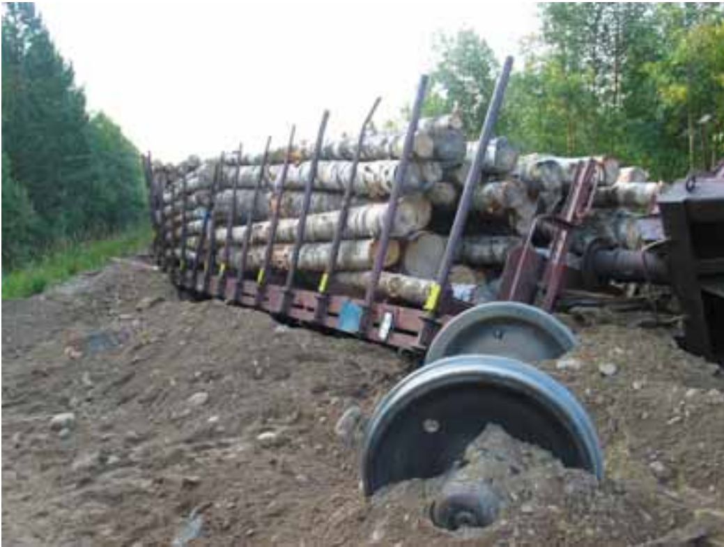
Kuva 3. Yhdeksän puutavaralastissa olleen tavaravaunun suistuminen Rantasalmella 31.7.2003. Osa vaunuista painui hiekkaan.
