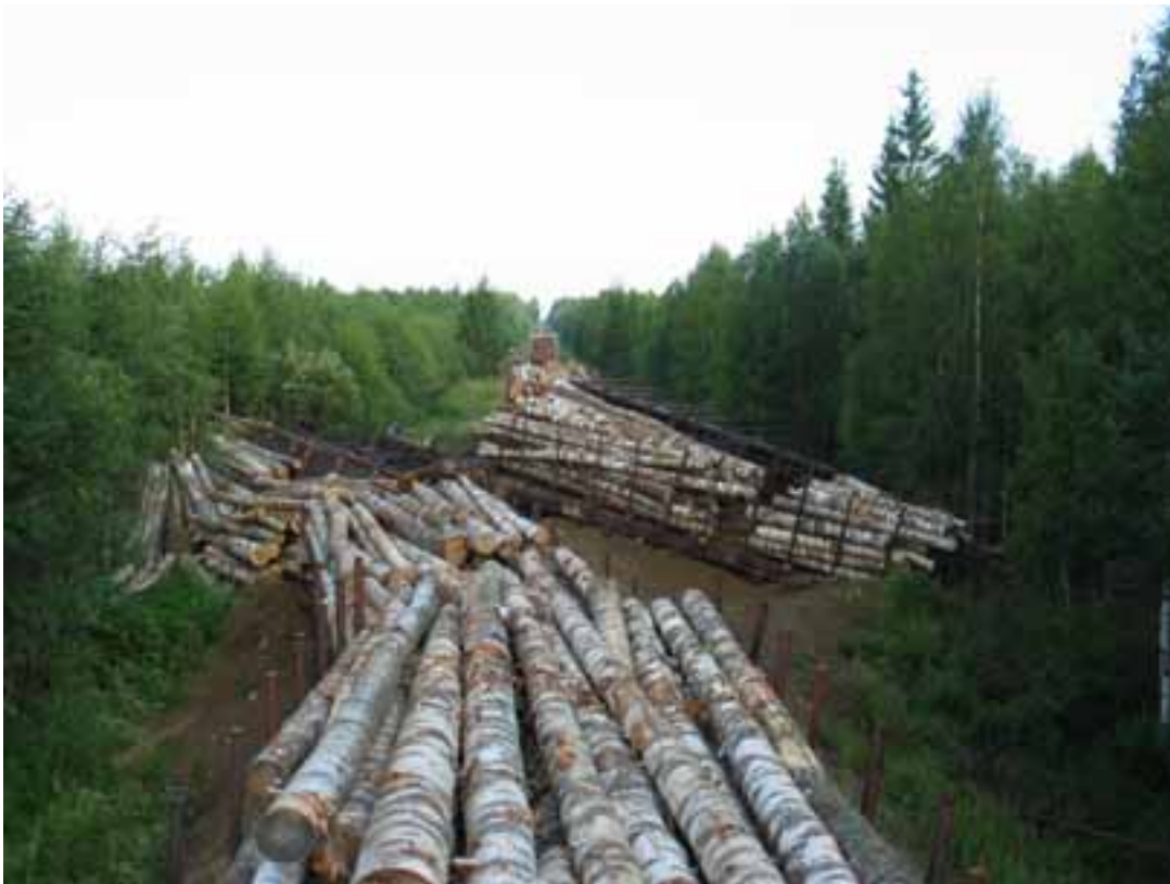
Kuva 1. Yhdeksän puutavaralastissa olleen tavaravaunun suistuminen Rantasalmella 31.7.2003. Kuva junan menosuuntaan päin.
