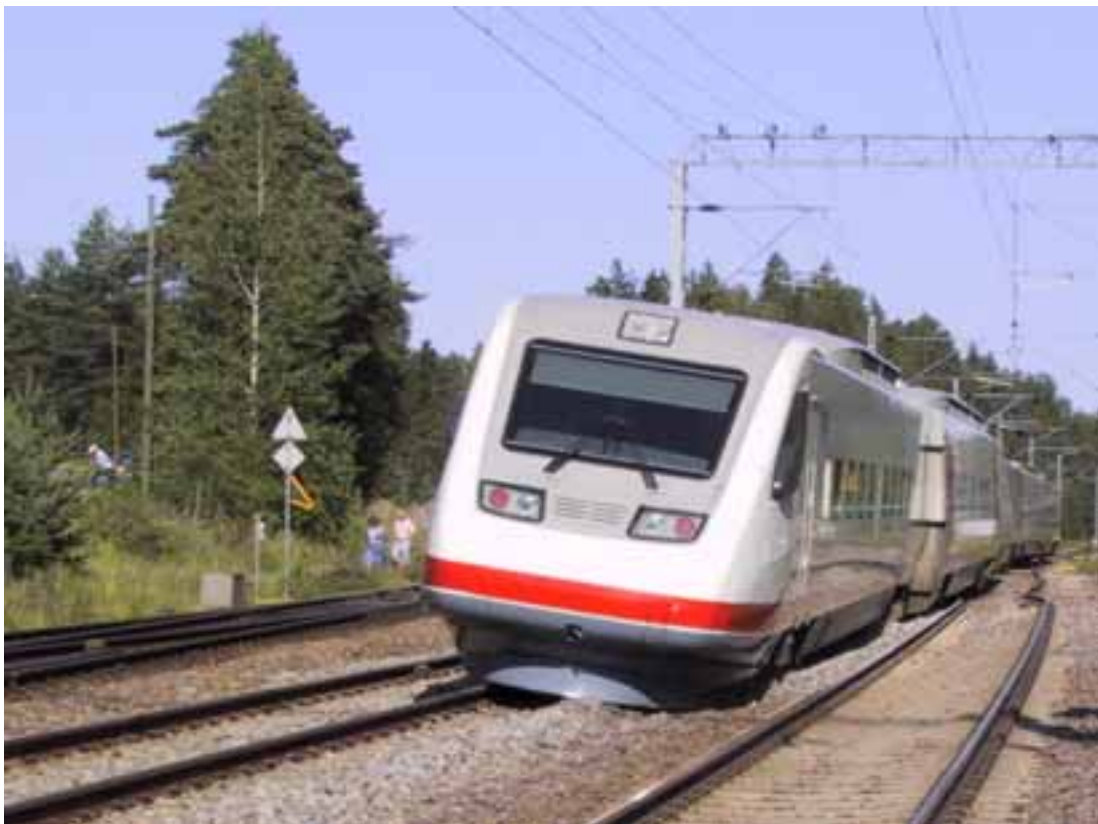
Kuva 3. Pendolino-junan suistuminen Karjaalla 25.7.2003. Junan etuosa etelän puolelta. Junan kuudesta vaunusta kolmesta suistui molemmat telit ja neljänestä vaunusta vain toinen.
