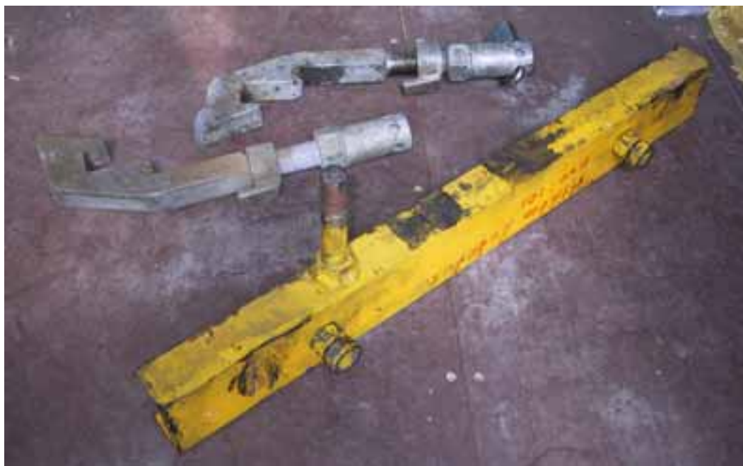
Kuva 4. Kaksi vaihteen kielen lukitsemiseen käytettävää tavallista kielisalpaa ja lukituskappale risteyksen kääntyvän kärjen lukitsemiseen. Kääntyvää risteyksen kärkeä varten olevan keltaisen teräksisen lukituskappaleen ovat valmistaneet Karjaan paikalliset asentajat.
