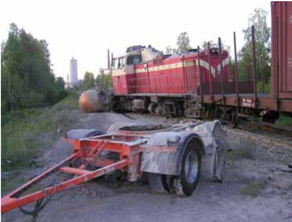
Kuva 1. Vaihtotyöyksikön ja sementtiä kuljettaneen ajoneuvoyhdistelmän törmäys Lappeenrannassa 1.7.2003. Kuva junan kulkusuuntaan. Kuvassa perävaunun irronnut etuteli.
