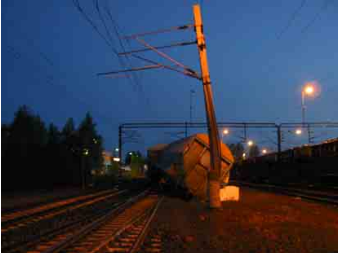
Kuva 2. Tavarajunan viimeisen vaunun laakerivaurio ja suistuminen Lahdessa 28.5.2003. Suistunut viimeinen vaunu.
