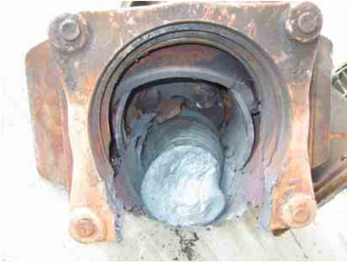
Kuva 4. Tavarajunan viimeisen vaunun laakerivaurio ja suistuminen Lahdessa 28.5.2003. Irronnut laakeripesä, jonka sisällä on katkennut akselin pää.
