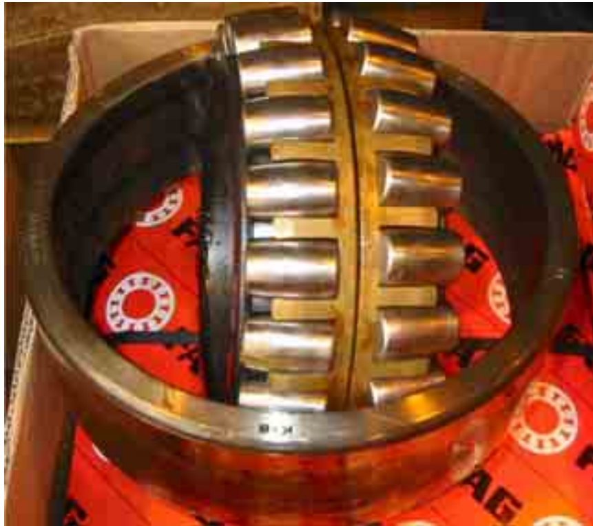
Kuva 2. Kaksirivinen rullalaakeri, jossa rullien pitimenä on messinkinen kampapidin.
