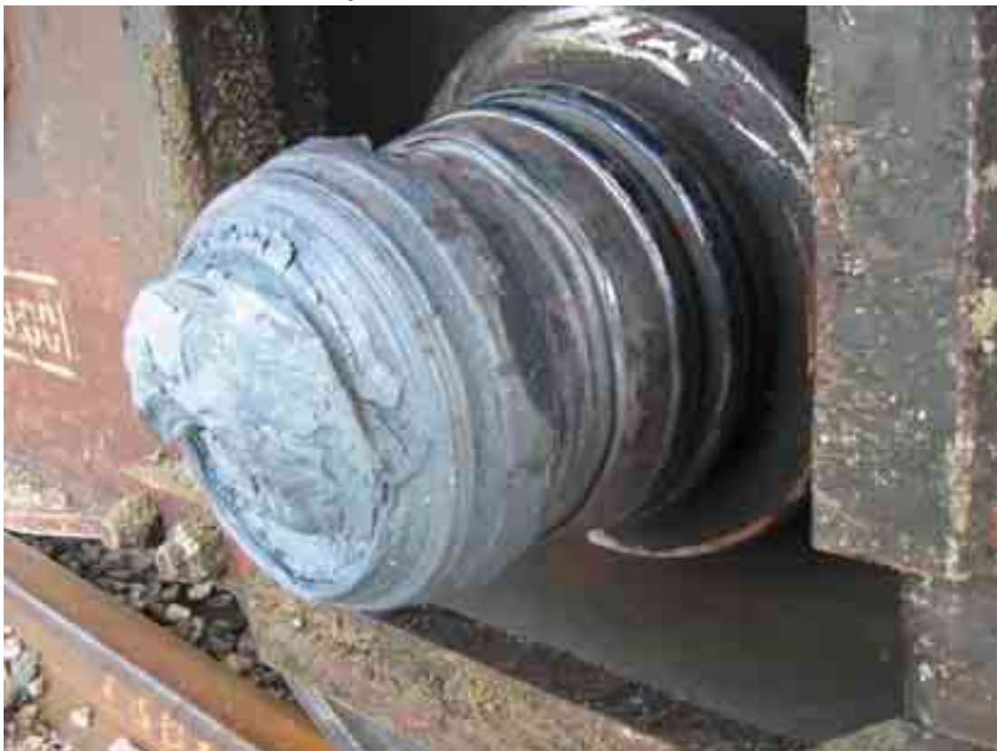
Kuva 3. Tavarajunan viimeisen vaunun laakerivaurio ja suistuminen Lahdessa 28.5.2003. Laakerin juuttuminen kuumensi akselin, joka katkesi.
