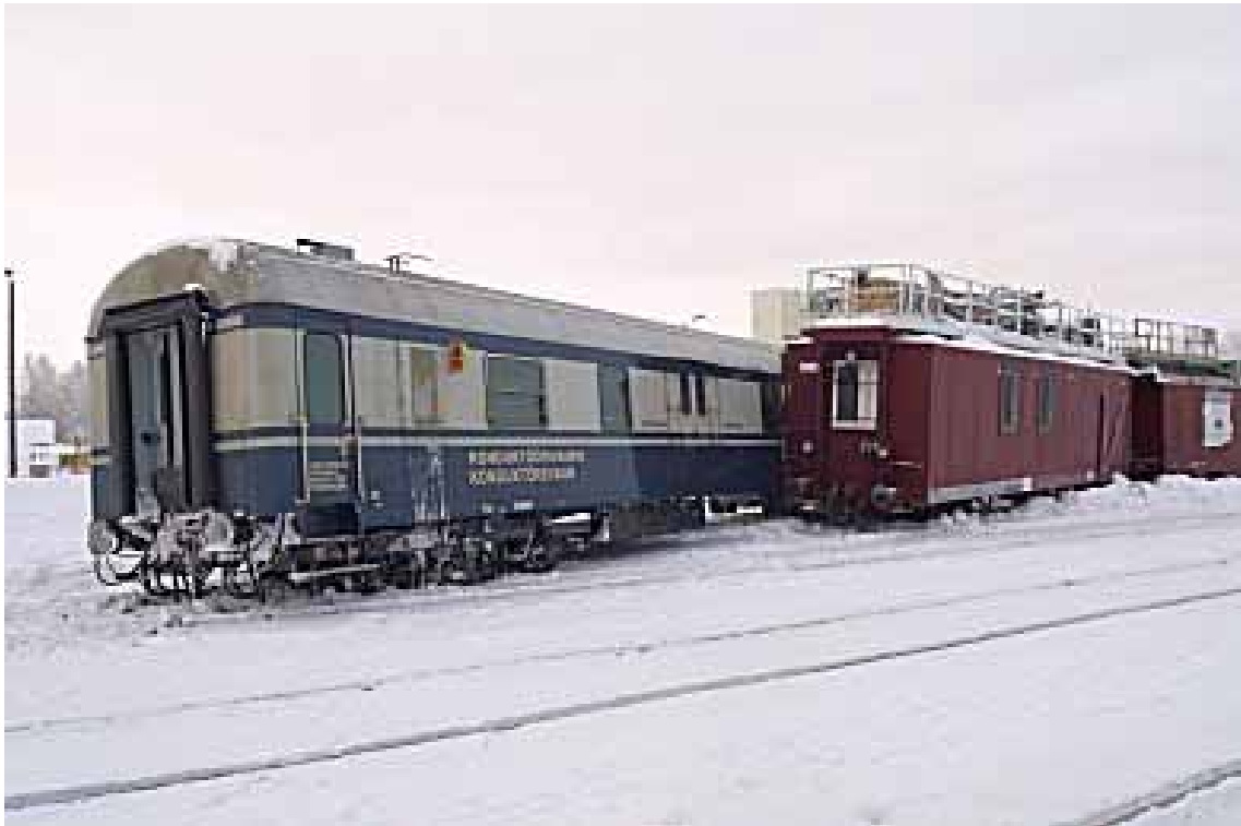
Kuva 4. Matkustajavaunun suistuminen kiskoilta Kemin asemalla 7.2.2003. Konduktööri-vaunu (Fot) ja sähkötyökunnan johdonvetovaunusto "Elmer".
