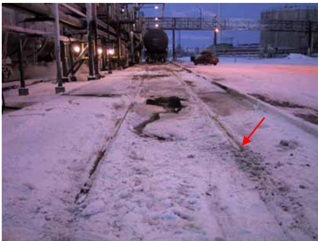
Kuva 2. Kolmen säiliövaunun suistuminen kiskoilta Haminan satamassa 3.1.2003. Etualalla näkyy taaimman vaunun liikkeellelähtöpaikka. Figure 2. Three tank wagons derailing at Hamina port, Finland, on January 3, 2003. In the foreground, the point of starting of the last wagon of the shunting unit.
