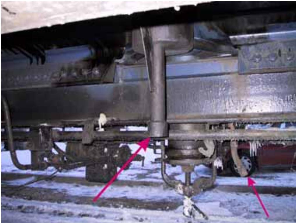
Kuva 3. Kolmen säiliövaunun suistuminen kiskoilta Haminan satamassa 3.1.2003. Höyrynsyötön yhde keskellä, poistoyhde oikealla alhaalla.
