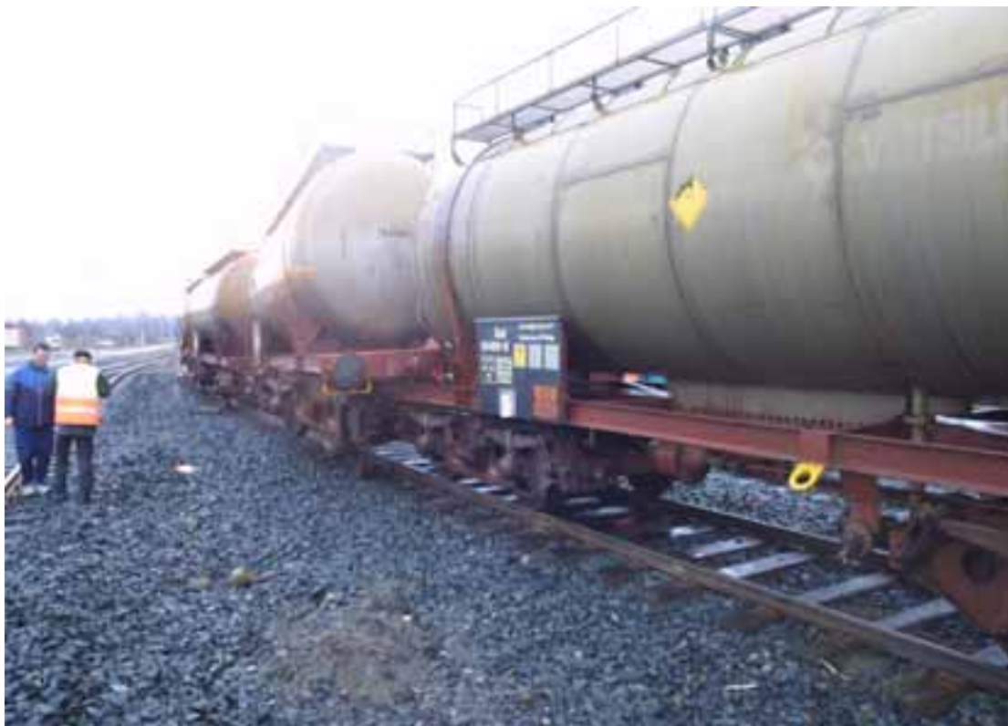
Kuva 2. Ensimmäisenä työnnetty vaunu nousi seisseen vaunun päälle siten, että sen puskinpalkki nousi seisseen vaunun runkopalkin päälle.
