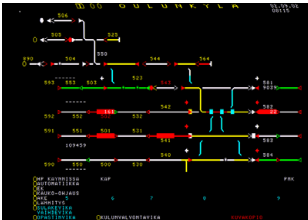
Kuva 4. Oulunkylän tilanne kauko-ohjaajan kuvaruudulla heti suistumisen jälkeen. Junanumero 9039 on jäänyt opastimen E 581 taakse ns. kuolleeksi junanumeroksi, kun yksikkö on ohittanut opastimen ilman asetettua kulkutietä. Siniset ruudut kolmen vaihteen kohdalla ilmaisevat vaihdevikaa.
