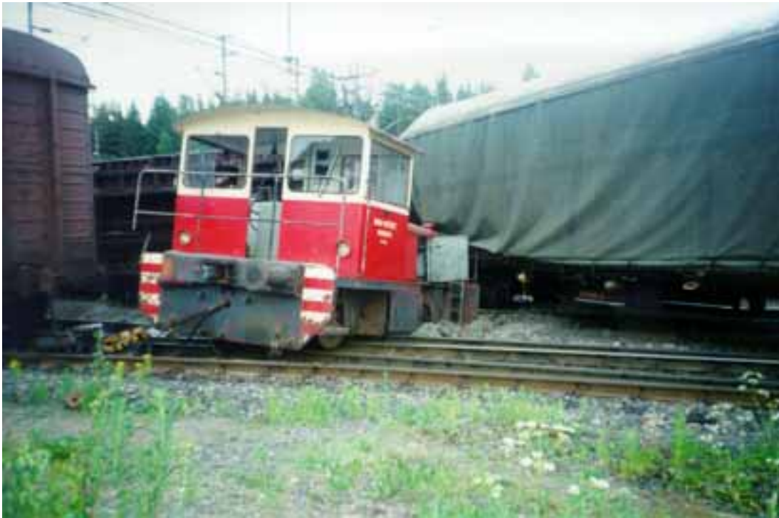
Kuva 2. Yksityisen päivystäjän törmääminen lähtevään tavarajunaan Kouvolan ratapihalla 6.6.2002. Kuvassa päivystysveturi ja vasemmalla siihen kytketyt vaunut.
