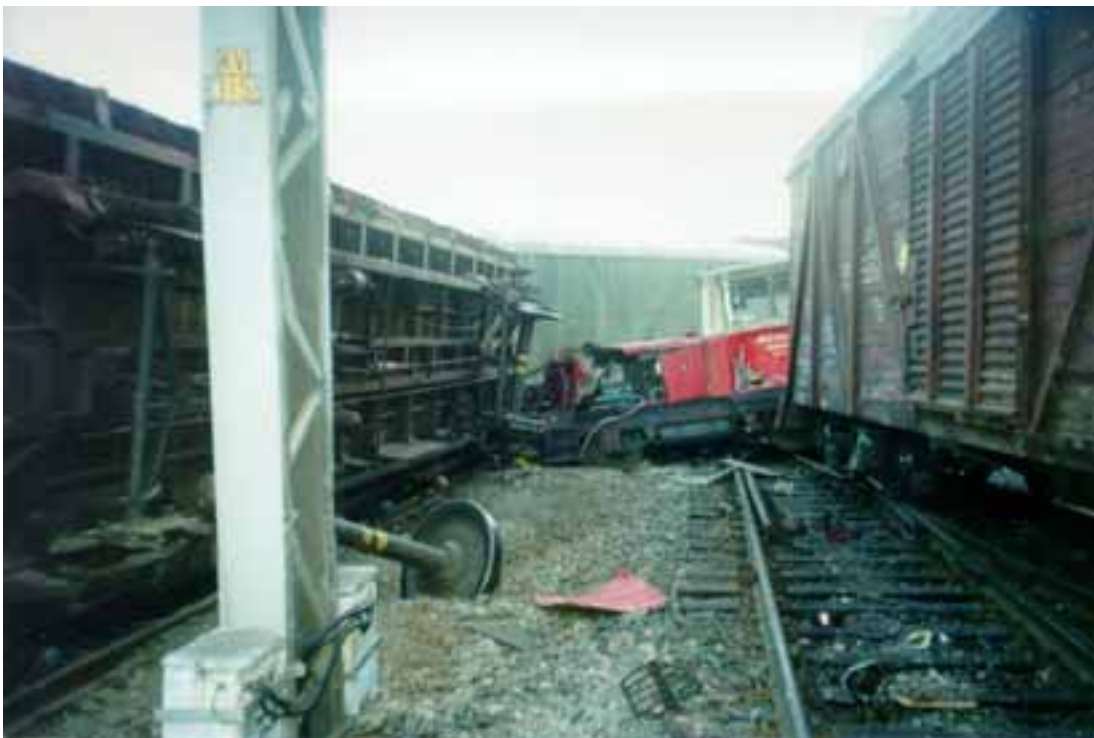
Kuva 3. Yksityisen päivystäjän törmääminen lähtevään tavarajunaan Kouvolan ratapihalla 6.6.2002. Päivystysveturiin kytketyt vaunut oikealla.
