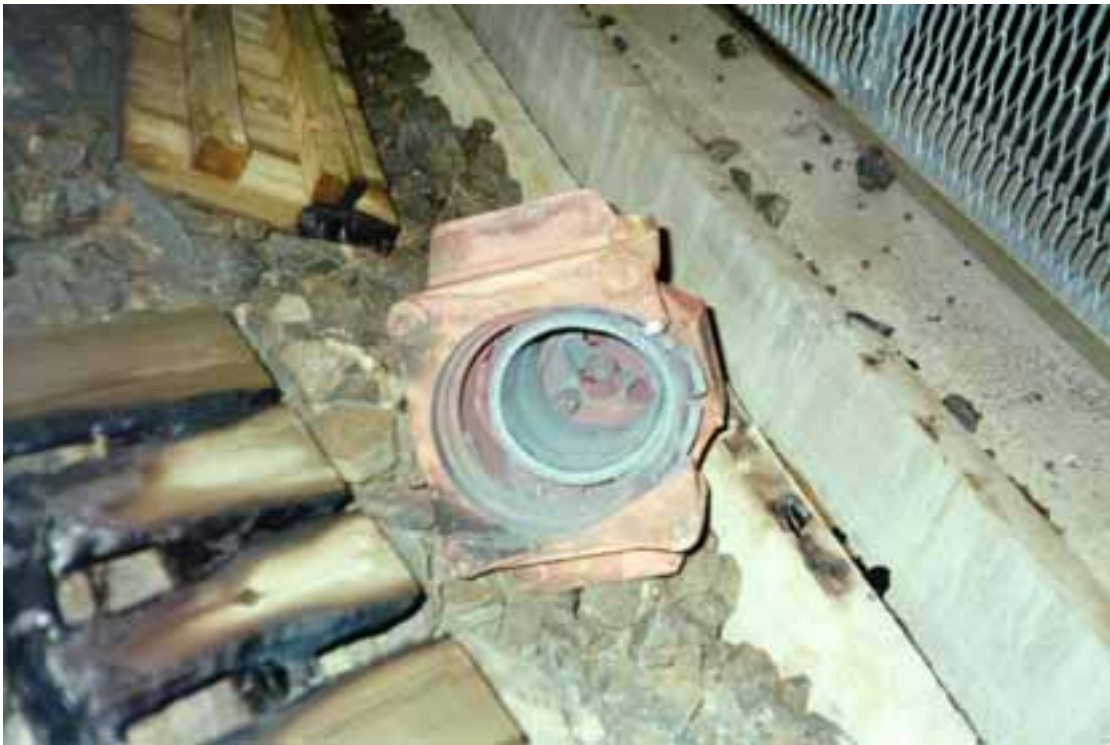
Kuva 2. Tavaravaunun laakerivaurio ja suistuminen Muhoksella 27.5.2002. Vaurioitunut laakeri Tikkalantien sillalla Muhoksen aseman länsipäässä. Katkennut akselinpää ei ole laakerissa kiinni. Laakeripesän sisällä oli laakeria avattaessa yksi katkeamaton kiinnityspultti.
