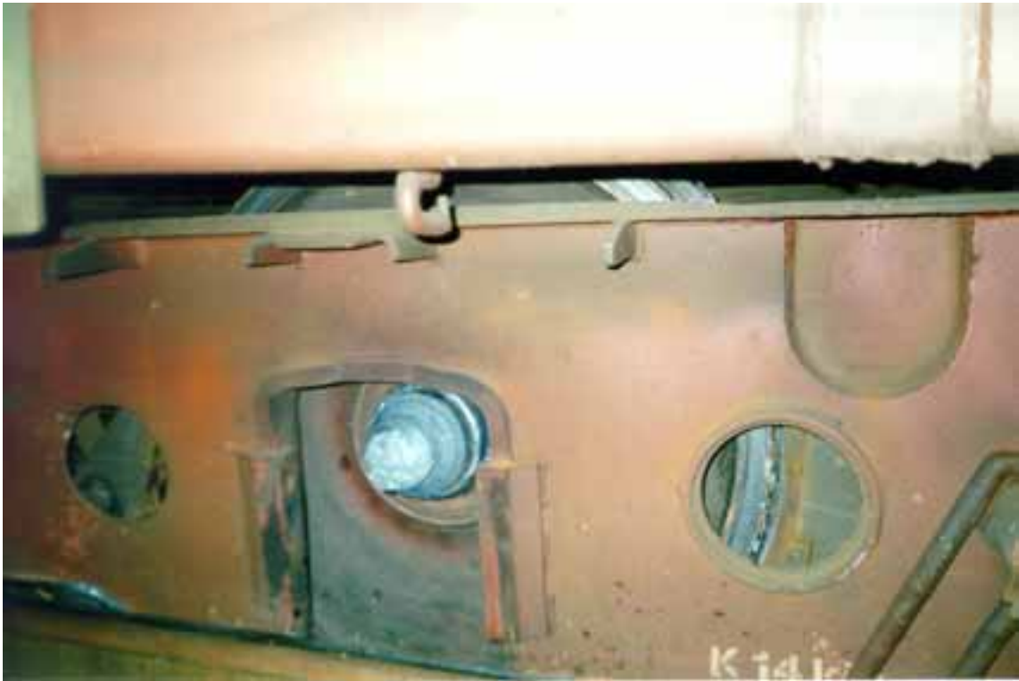
Kuva 4. Tavaravaunun laakerivaurio ja suistuminen Muhoksella 27.5.2002. Katkennut akselinpää.
