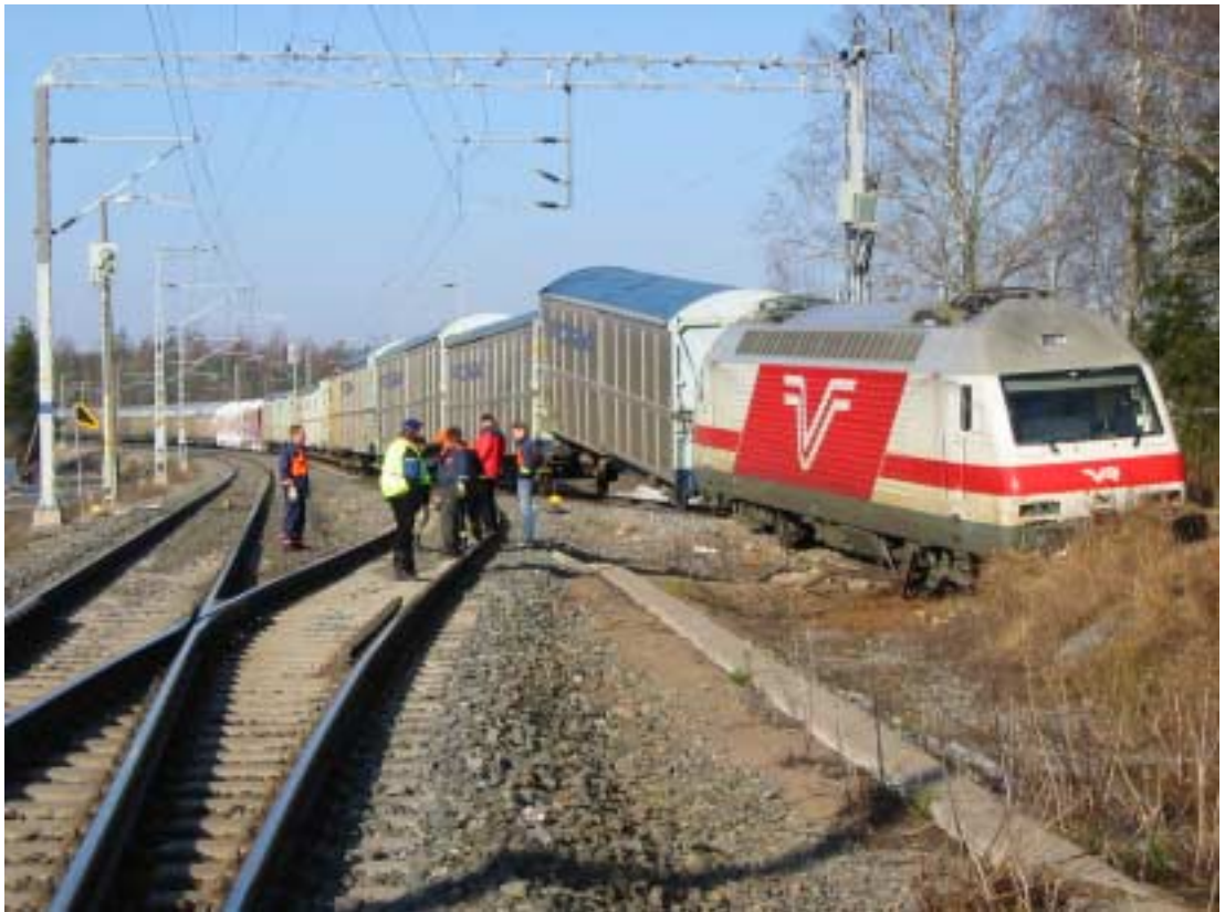
Kuva 3. Tavarajunan ajo läpi raidepuskimen Suoniemellä 11.4.2002. Figure 3. Freight train passing rail barrier at Suoniemi, Finland, on 11 April 2002.
