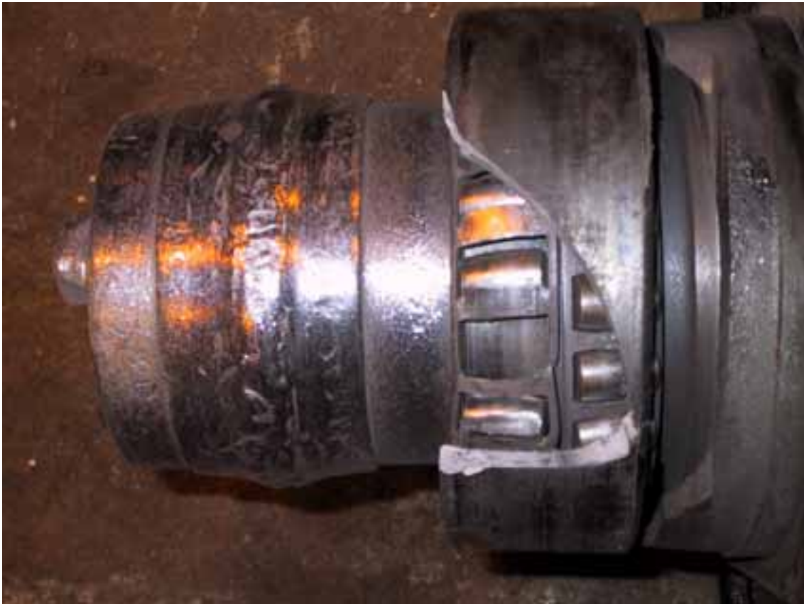
Kuva 3. Säiliövaunun laakerivauriosta aiheutunut vaaratilanne Viialassa 11.2.2002. Ulompi laakeri tuhoutui täysin ja sisempikin alkoi rikkoontua.
