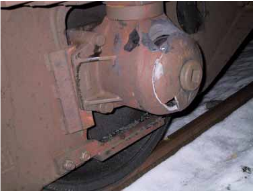
Kuva 1. Säiliövaunun laakerivauriosta aiheutunut vaaratilanne Viialassa 11.2.2002. Rik- koutunut laakeripesä kuvattuna Viialan ratapihalla. Pyörän etupinta oli täysin laa- kerirasvan likaama.
