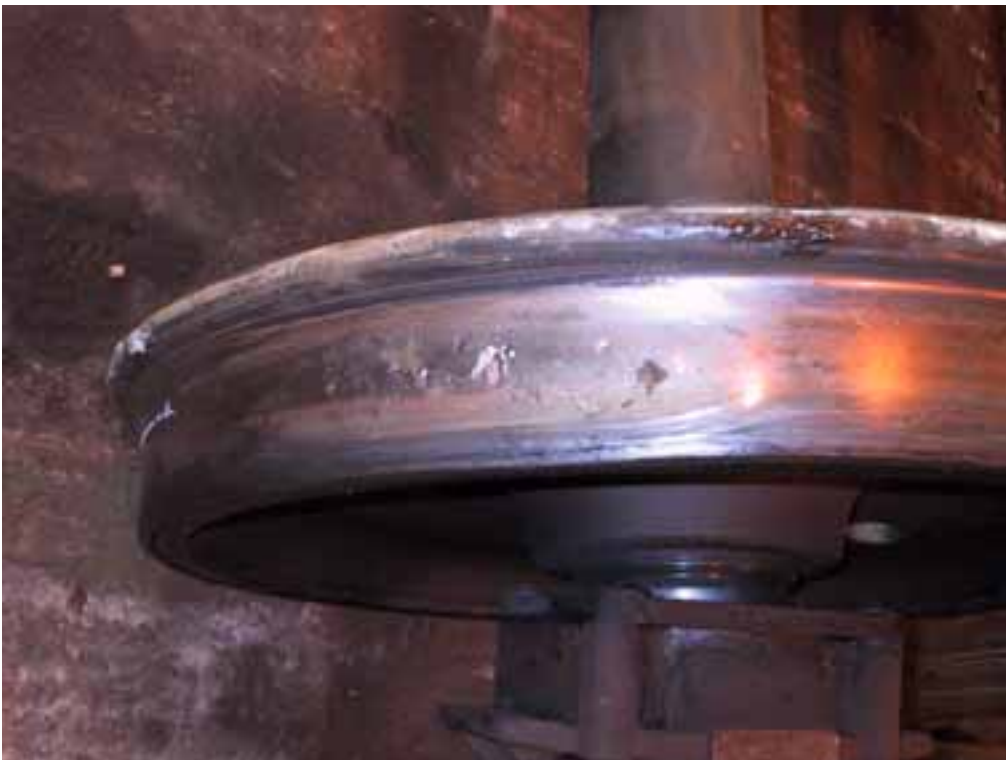
Kuva 2. Säiliövaunun laakerivauriosta aiheutunut vaaratilanne Viialassa 11.2.2002. Pyö- rässä ollut suurempi lovi oli pituudeltaan 310 mm.
