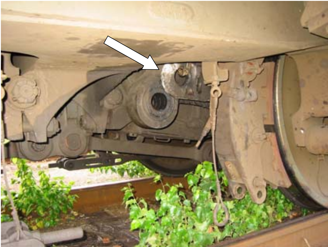
Kuva 2. Veturin pyöräkerran suistuminen kiskoilta Riihimäen ratapihalla 31.7.2001. Nuoli osoittaa akselinkäyttölaitteen kiinnityskorvaketta, joka vaihteen vastakiskossa nosti pyörän ylös ja pois kiskoilta. Nuolen alapuolella näkyy ripustimen alapään reikä, josta tappi oli pudonnut.
