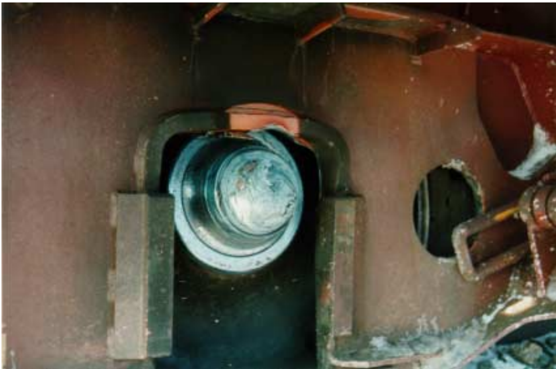
Kuva 2. Tavaravaunun suistuminen kiskoilta Oulaisissa 4.3.2001. Katkennut akseli. Suistunut vaunu oli neliakselinen vaunu, jonka telirakenne mahdollisti kiskoilla pysymisen jopa 23 km laakeripesän putoamisen jälkeen. Figure 2. Freight wagon derailing at Oulainen on 4 March, 2001. The broken axle. Bogie structure of four axle wagon enabled the wagon to stay on rails even 23 km after the bearing housing had fell off.
