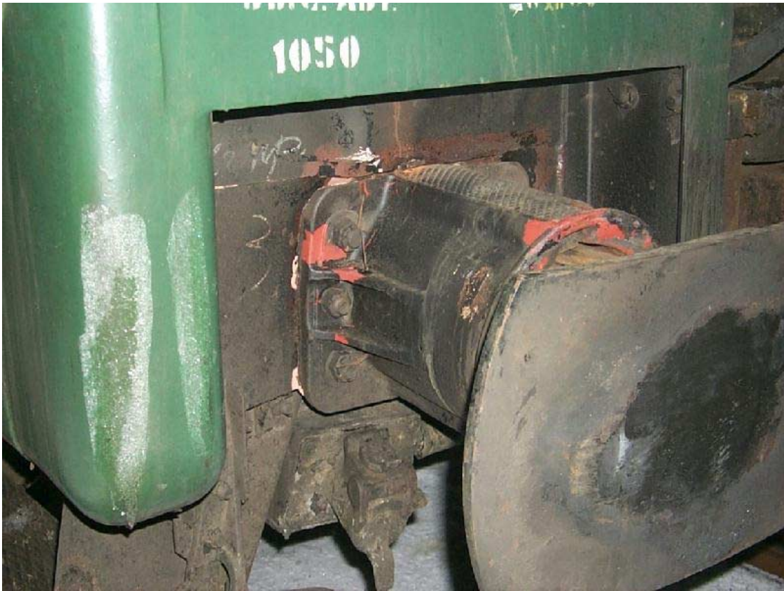
Kuva 4. Veturin törmääminen matkustajavaunuihin Ilmalassa 6.1.2001. Törmäyksessä vaurioitui mm. sivupuskimia ja puskinpalkkeja.
