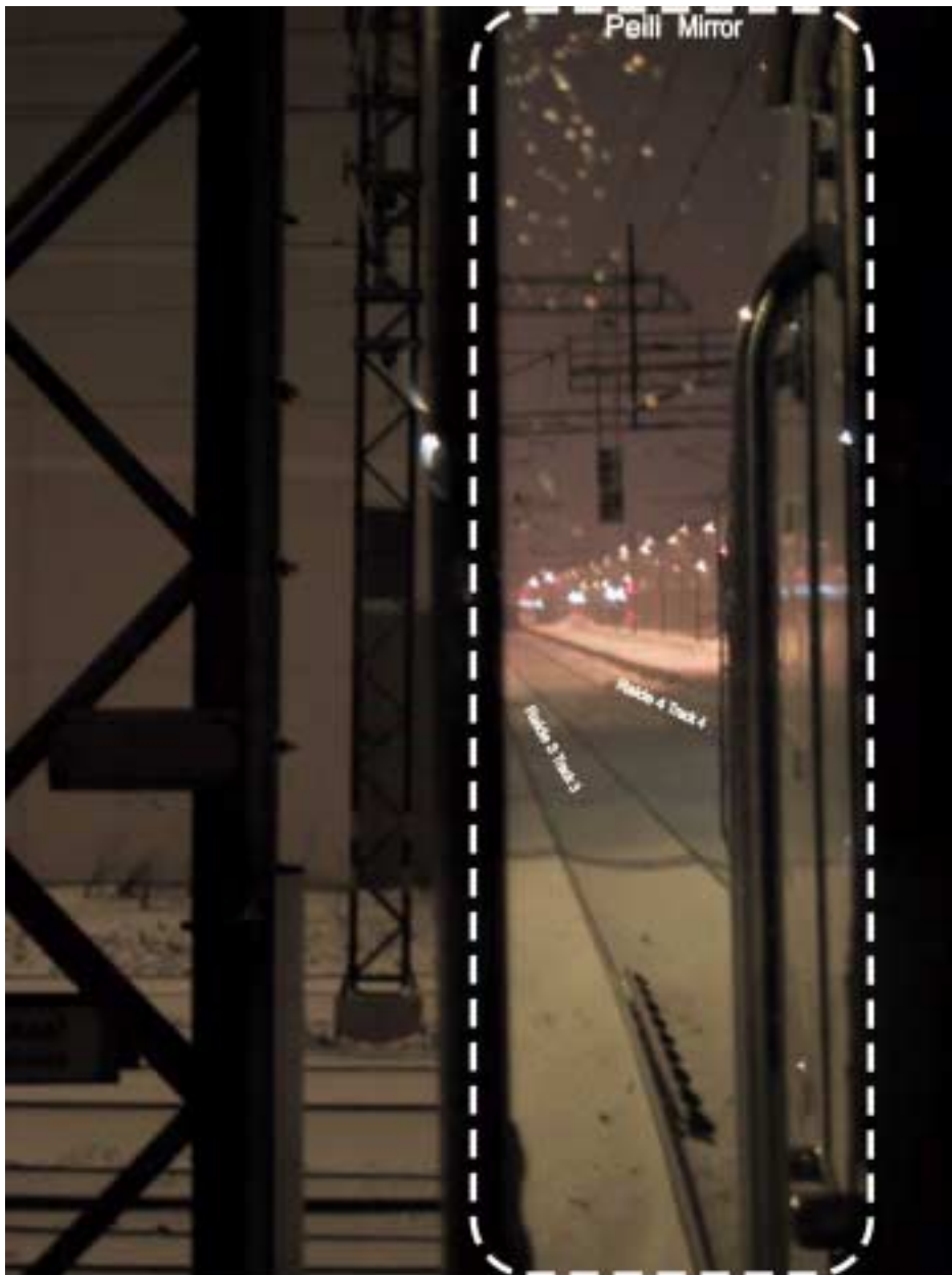
Kuva 8. Veturin törmäminen paikallaan olleen matkustajajunan perään Tampereella 2.11.2001. Vaunuihin törmänneen veturin kuljettaja ajoi veturia sen takapäin ohjaimosta peileistä tähyestäen. Raiteella 4 ollut juna oli mahdollista nähdä kaarteon kohdalla peilistä, mutta suoralla osuudella oma veturi peittää näkyvyyden lähes kokonaan. Kuvassa veturin vasen peili, jonka kautta näkyvät raiteet kolme ja neljä. Raide 4 on kuvassa oikealla.
