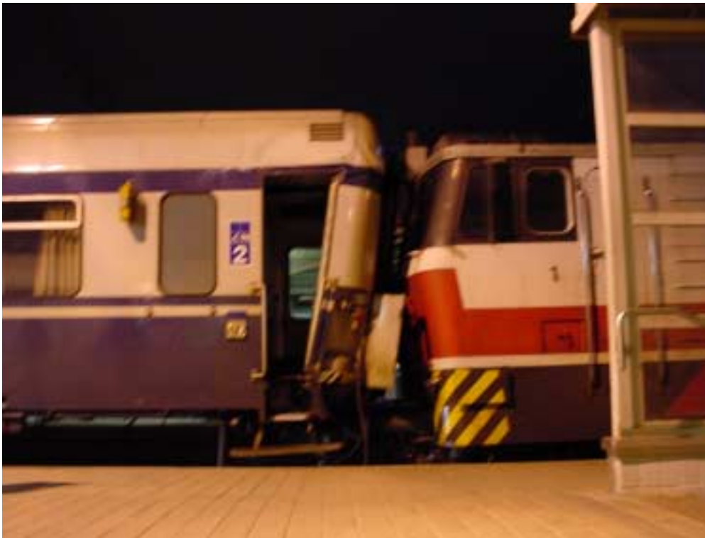
Kuva 1. Veturin törmäminen paikallaan olleen matkustajajunan perään Tampereella 2.11.2001. Törmäyskohta.
