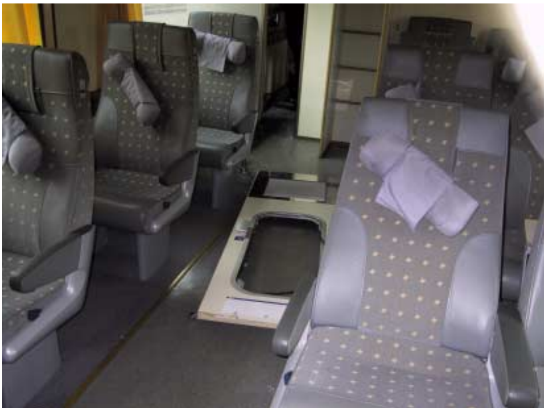
Kuva 4. Veturin törmäminen paikallaan olleen matkustajajunan perään Tampereella 2.11.2001. Vaunujen sisällä irtosi muun muassa osastojen välisiä ovia.
