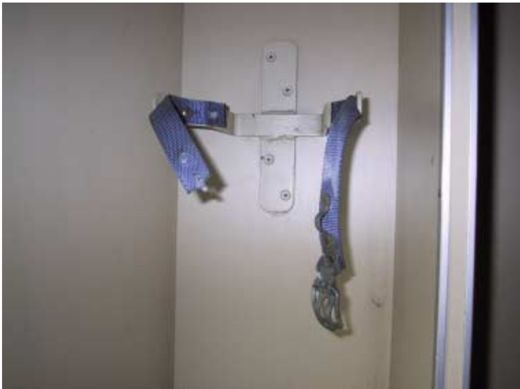
Kuva 6. Veturin törmääminen paikallaan olleen matkustajajunan perään Tampereella 2.11.2001. Keskimmäisen vaunun eteisessä olleen sammuttimen kiinnityshihnan solki irtosi ja sammutin lensi lattialle. Sammuttimen kokonaispaino oli yli 17 kg.
