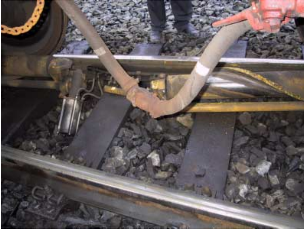
Kuva 2. Säiliövaunujen suistuminen kiskoilta Tampereen laskumäessä 1.12.2000. Kuvassa suistumisen aiheuttanut raidejarru.
