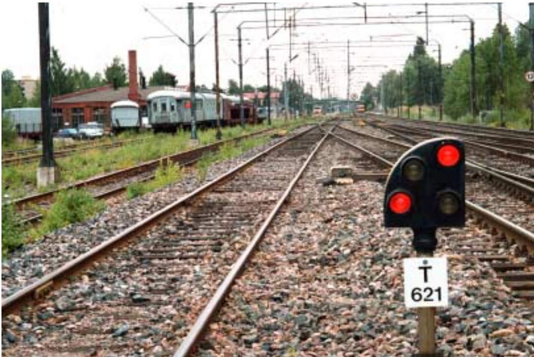
Kuva 3. Raideopastimen "seis"-opasteen ohittamisesta aiheutunut vaaratilanne Keravalla 15.7.1999. Juna ohitti raideopastimen T621, joka näytti "seis"-opastetta ja ajoi taustalla näkyvän vaihteen auki. Vastakkaiseen suuntaan kulkevalle H-junalle oli asetettu kulkutie ko. vaihteen kautta.
