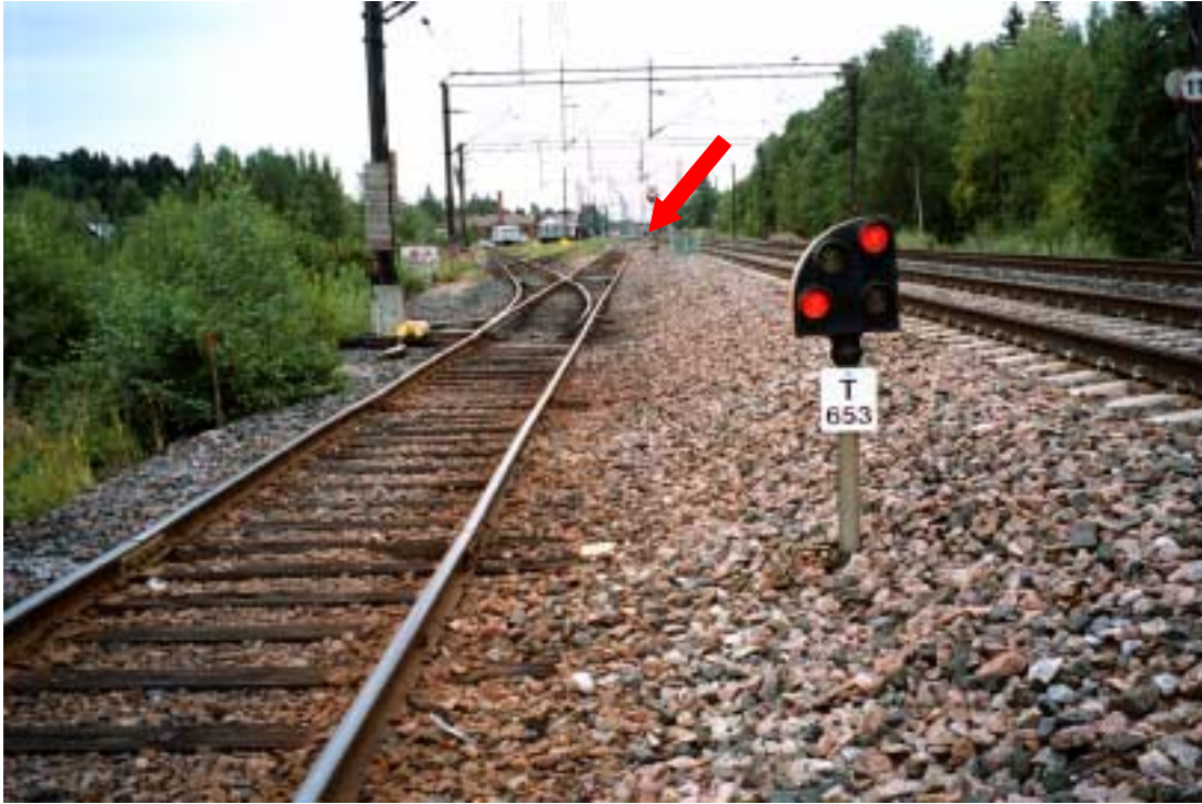
Kuva 2. Raideopastimen "seis"-opasteen ohittamisesta aiheutunut vaaratilanne Keravalla 15.7.1999. Raideopastin T653 vaihtui näyttämään "aja varovasti"-opastetta, minkä jälkeen veturinkuljettaja lähti liikkeelle. 140 metrin päässä oleva nuolella merkitty seuraava raideopastin oli mahdollista nähdä ohjaamosta selvästi.
