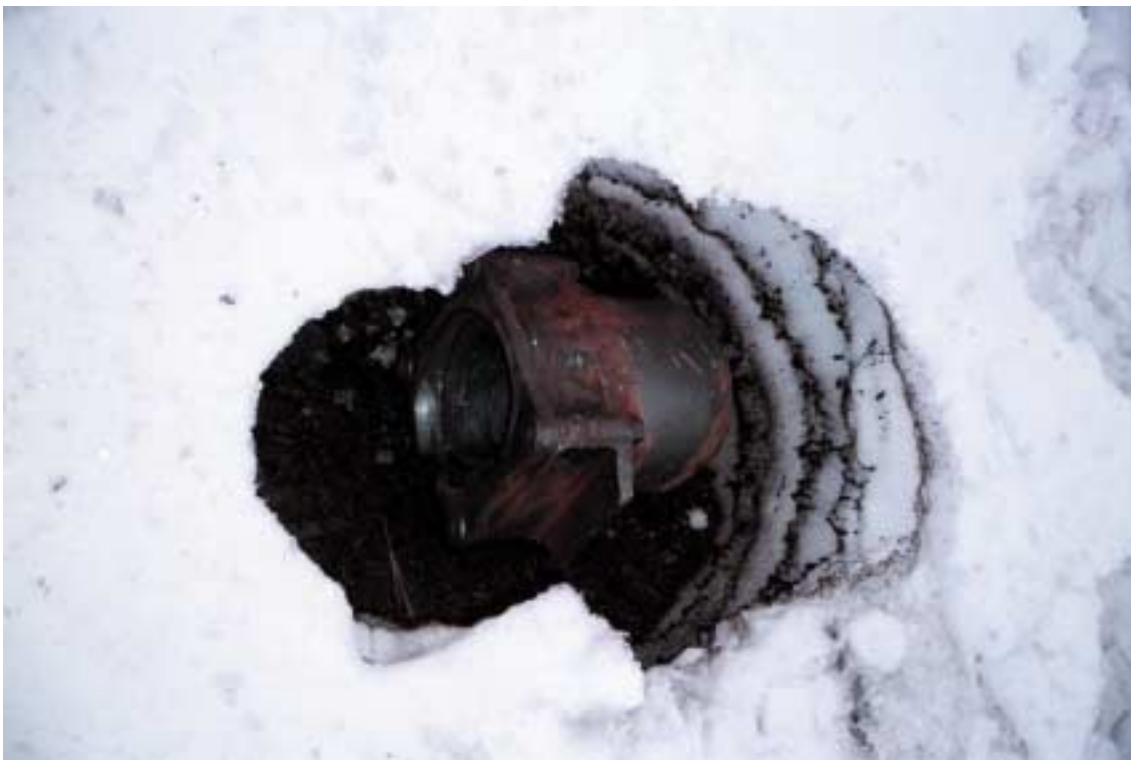
Kuva 3. Tavarajunan suistuminen kiskoilta Jalasjärvellä 19.2.1999. Laakeri kuumeni ja vaurioitui. Kun laakeri lopulta juuttui, punahehkuisseksi kuumentunut akseli kat- kesi ja laakeripesä irtosi. Katkenneen akselin pää on laakeripesän sisällä.
