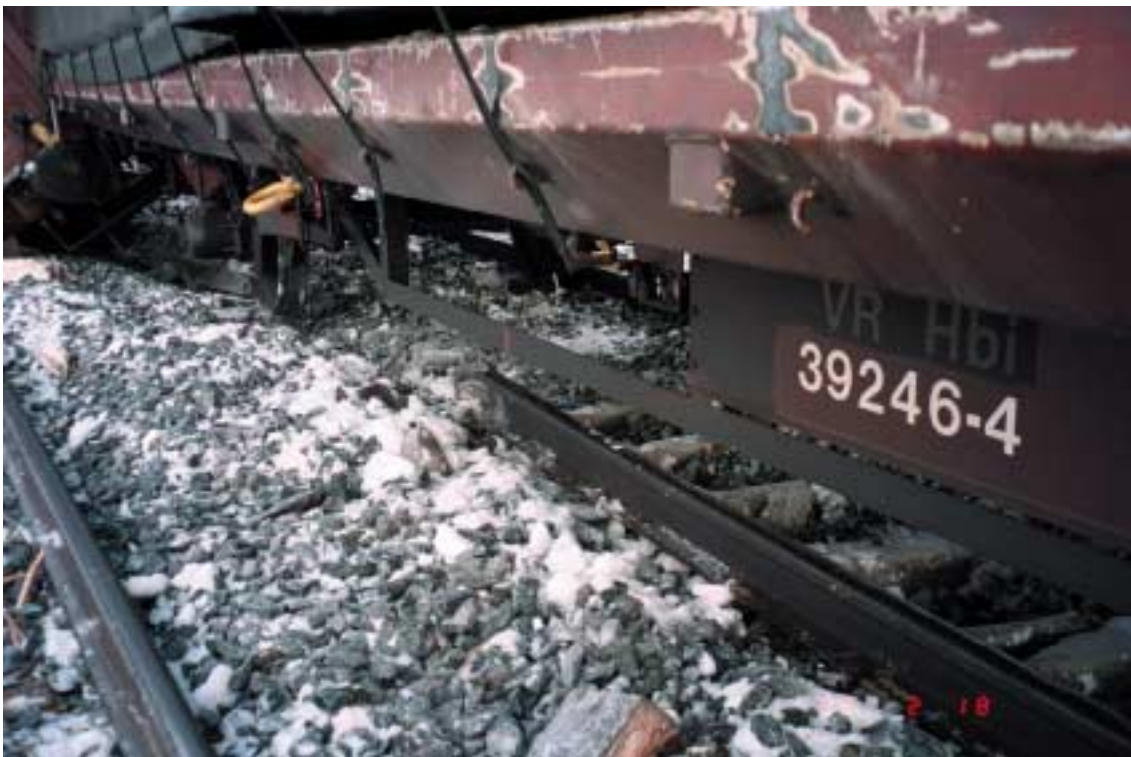
Kuva 7. Tavarajunan suistuminen kiskoilta Jalasjärvellä 19.2.1999. Kun vaunu pyörähti ympäri, myös perässä tulleet 14 vaunua suistuivat. Tällöin rata vaurioitui pahoin.
