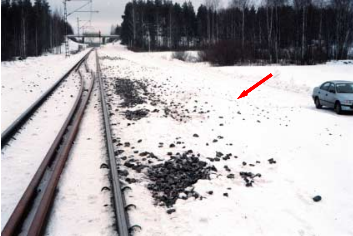
Kuva 2. Tavarajunan suistuminen kiskoilta Jalasjärvellä 19.2.1999. Hbi-sahatavaravau- nun akseli katkesi laakerin juuttumisen seurauksena. Tällöin laakeripesä ja jou- sipakka lensivät radan varteen jättäen jäljet lumeen ja sepeliin. Paikka, jonne laakeripesä vieri, on merkitty nuolella.
