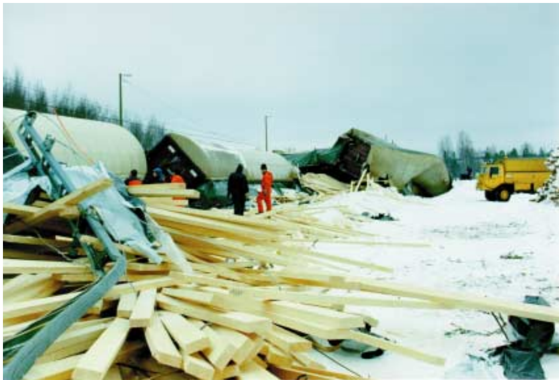
Kuva 9. Tavarajunan suistuminen Jalasjärvellä 19.2.1999. Lähes kaikkien suistuneiden vaunujen peitekankaasta valmistetut sivupeitteet repesivät ja sahatavara levisi ratapiha-alueelle. Kuvassa näkyy myös rikkoontunut sähkörataportaali.
