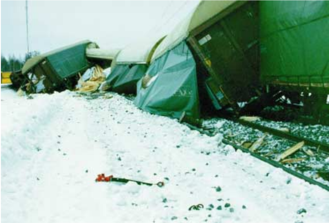
Kuva 8. Tavarajunan suistuminen kiskoilta Jalasjärvellä 19.2.1999. Suistuneet vaunut törmäilivät toisiinsa ja kallistuivat tai kaatuivat. Kolme kuvassa näkyvää vaunua vaurioituivat pahoin niiden kasautuessa radan vasemmalle puolelle.
