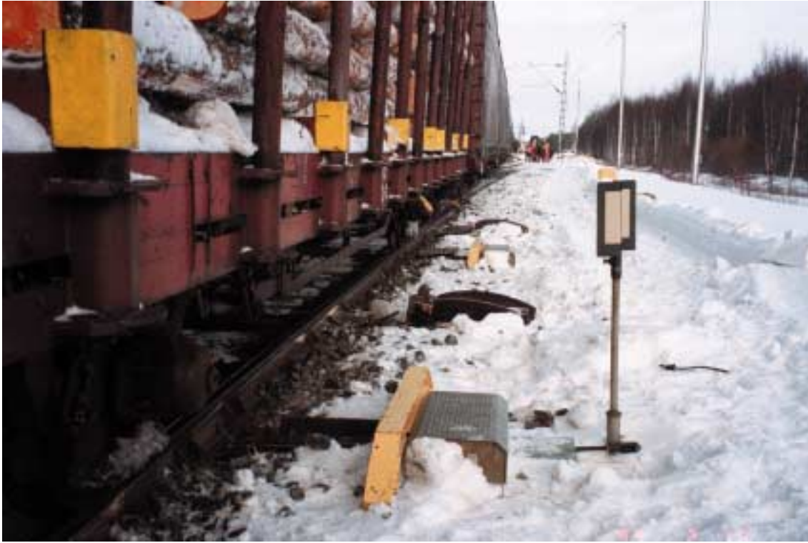
Kuva 6. Tavarajunan suistuminen kiskoilta Jalasjärvellä 19.2.1999. Jalasjärven ratapihan eteläpään vaihteessa kiskon vieressä kulkenut pyörä ajautui oikealle. Vaunu kääntyi perässä tulleen vaunun työntämänä poikittain ja pyörähti perä me-nosuuntaan.
