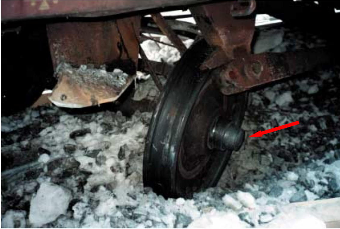
Kuva 10. Tavarajunan suistuminen kiskoilta Jalasjärvellä 19.2.1999. Onnettomuuden välitön syy oli laakerin ylikuumentumisesta ja juuttumisesta seurannut akselin kurotuminen ja katkeaminen. Laakeripesä ja n. 15 cm pitkä akselin pää puuttuvat.
