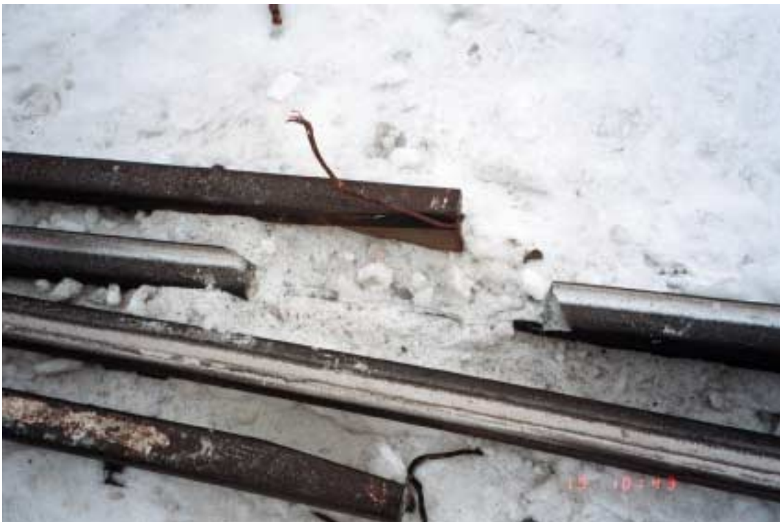
Kuva 5. Tavarajunan suistuminen kiskoilta Jalasjärvellä 19.2.1999. Kiskon vierellä kulkenut pyörä osui rajusti Ylivallin ratapihan pohjoispäässä olevan vaihteen risteykseen irrottaen palan kiskoa. Myös risteyksen hitsaus repeesi.
