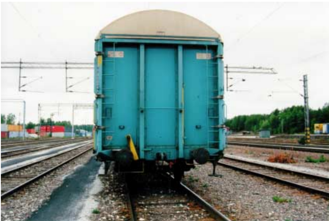
Kuva 3. Junamiehen loukkaantuminen vaihtotyössä Lappeenrannassa 12.8.1999. Vaihtotyöyksikön puoleisen vaunun pääty. Vaunu on varustettu vetokoukulla ja ruuvikytkimellä.
