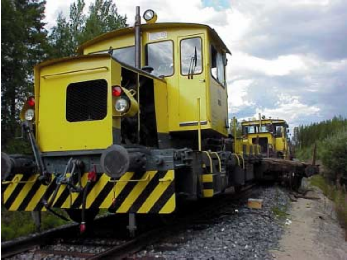
Kuva 3. Kahden ratakuorma-auton yhteentörmäys Korkeakoskella 18.8.1999. Etualalla Tka 155 ja taaempänä Tka 233. Ratakuorma-autojen väliin jäi Tka 155:n perässä ollut vaunu. Vaunu putosi kiskoilta.
