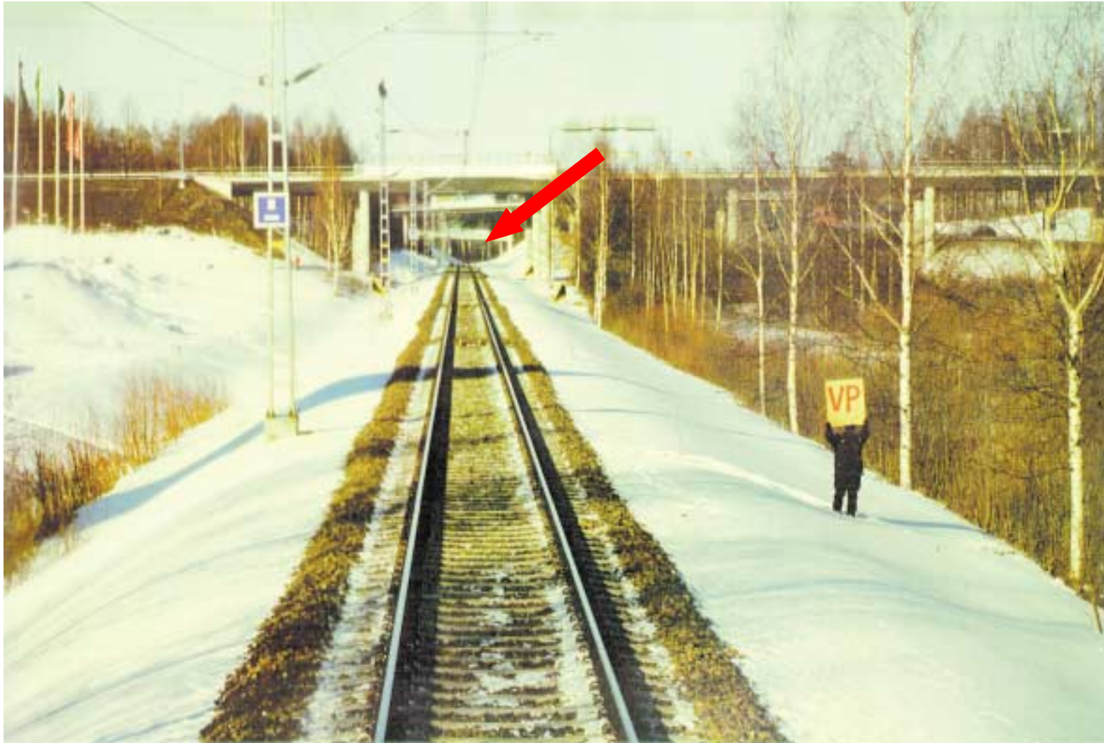
Kuva 1. Junaonnettomuus Jyväskylässä 6.3.1998. Juna tuli nopeudella 143 km/h erotusjaksolle, mistä on 2,6 km suistumisvaihteeseen. Tässä veturinkuljettaja käänsi virtapyörästä veturin tehot pois (VP) ja juna alkoi rullata. Taustalla viimeisen sillan kohdalla (nuoli) näkyy esiopastin.
