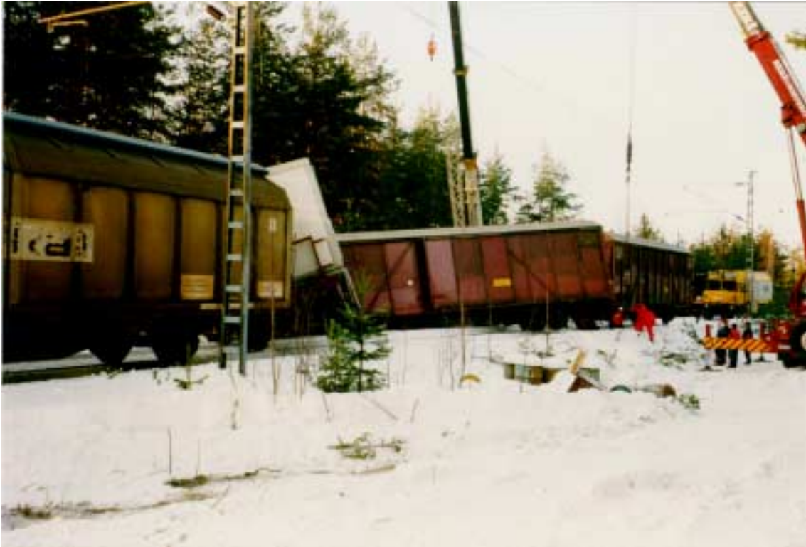
Kuva 7. Pahimmin suistuneet BXE-asuntovaunu ja katettu Gblk-vaunu nro 50279-9. Gblk nro 49638-0 on jo nostettu kiskoille.
