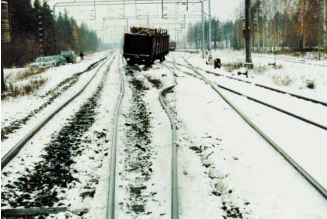
Kuva 2. Tavaravaunun suistuminen kiskoilta Lauritsalassa 7.11.1997. Suistunut vaunu, suistuneena kulkeneen vaunun tekemiä jälkiä sekä mutkat kiskoissa.
