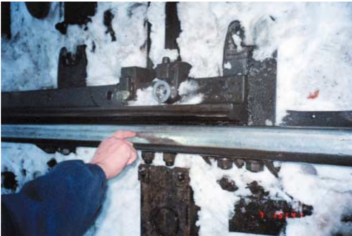
Kuva 3. Tavaravaunun suistuminen kiskoilta Lauritsalassa 7.11.1997. Suistumisen alku-kohta: Pyörän laippa on noussut vaihteen kielen päälle ja edelleen kiskon päälle. Huom. vaihteen kieli on eri asennossa kuin onnettomuushetkellä.
