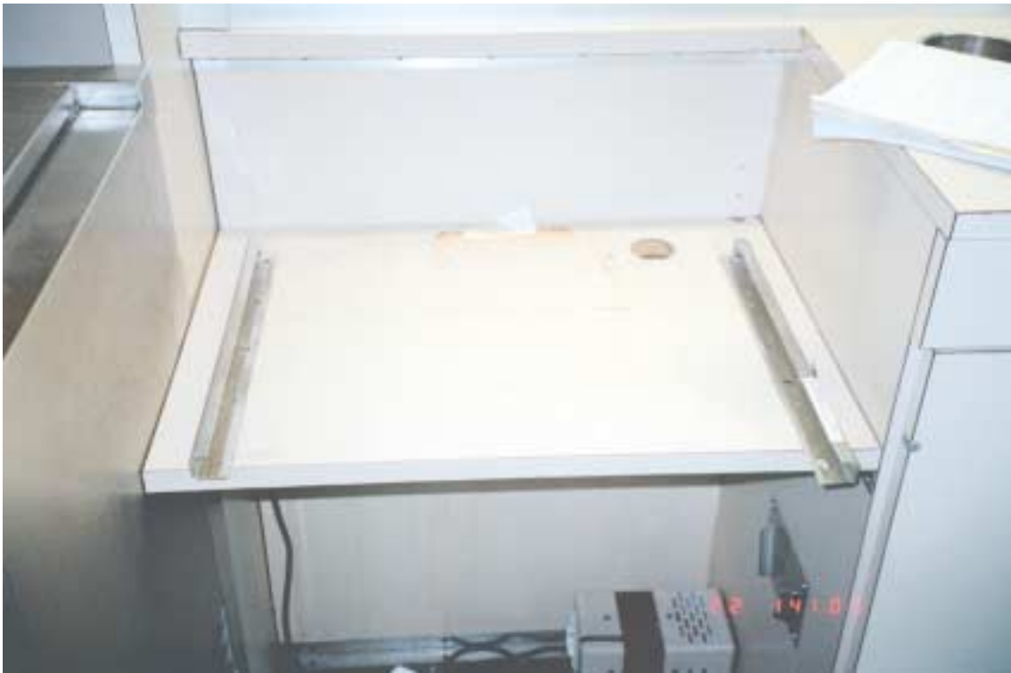
Kuva 5. Peruuttavan junan törmääminen paikallaan seisseisiin vaunuihin Ilmalassa 20.9.1997. Paikka jossa junaemännän päälle lentänyt kassakone oli sekä kassakoneen kiinnityskiskot.
