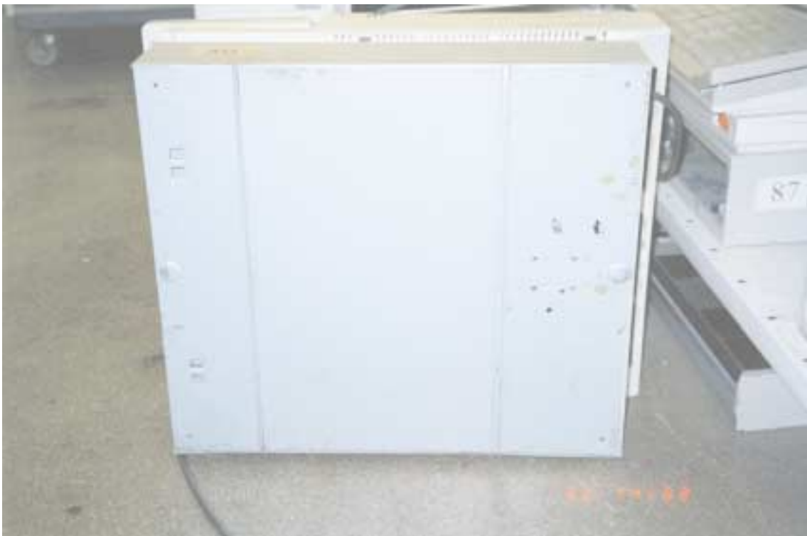
Kuva 6. Peruuttavan junan törmääminen paikallaan seisseisiin vaunuihin Ilmalassa 20.9.1997. Junaemännän päälle lentänyt kassakone. Kuvan 5. kiskoihin kiinnittämiseen tarvittavaa aluslevyä ei ollut jolloin kassakone oli irrallaan kiskojen välisellä tasolla.
