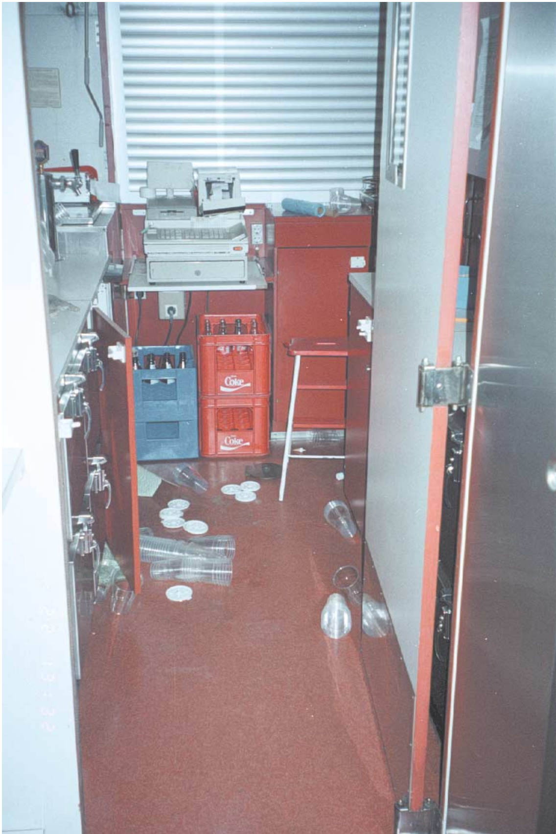
Kuva 7. Peruuttavan junan törmääminen paikallaan seisseisiin vaunuihin Ilmalassa 20.9.1997. Kassakoneen paikka keittiössä sekä kiinnityslevy johon kassakone kiinnitetään ruuveilla. Kuvattu paikallaan seisseen junarungon toisesta ravintolavaunusta.
