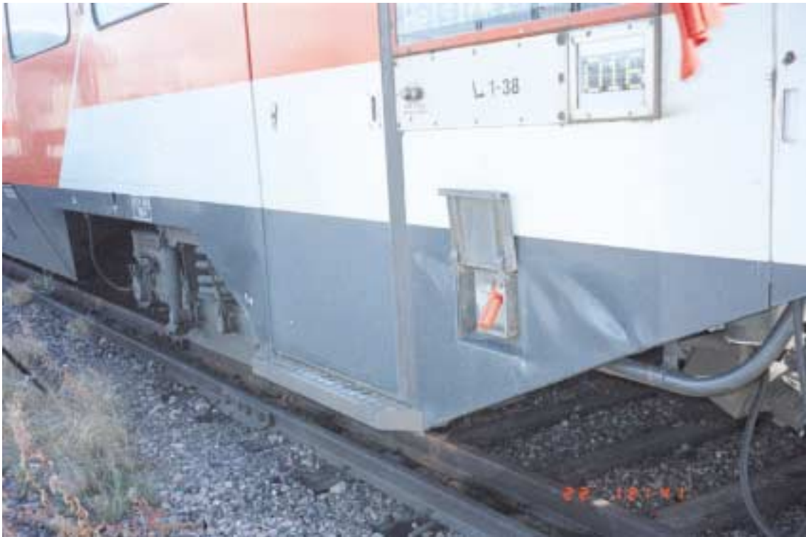
Kuva 3. Peruuttavan junan törmääminen paikallaan seisseisiin vaunuihin Ilmalassa 20.9.1997. Lommahduksia aiheutui törmänneen junan vaunun alaosaan sekä oven etu että takapuolelle.
