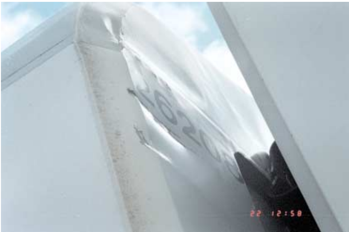
Kuva 4. Peruuttavan junan törmääminen paikallaan seisseisiin vaunuihin Ilmalassa 20.9.1997. Edellisen vaunun aikaansaamia vaurioita törmänneen junan vaunun yläosassa.
