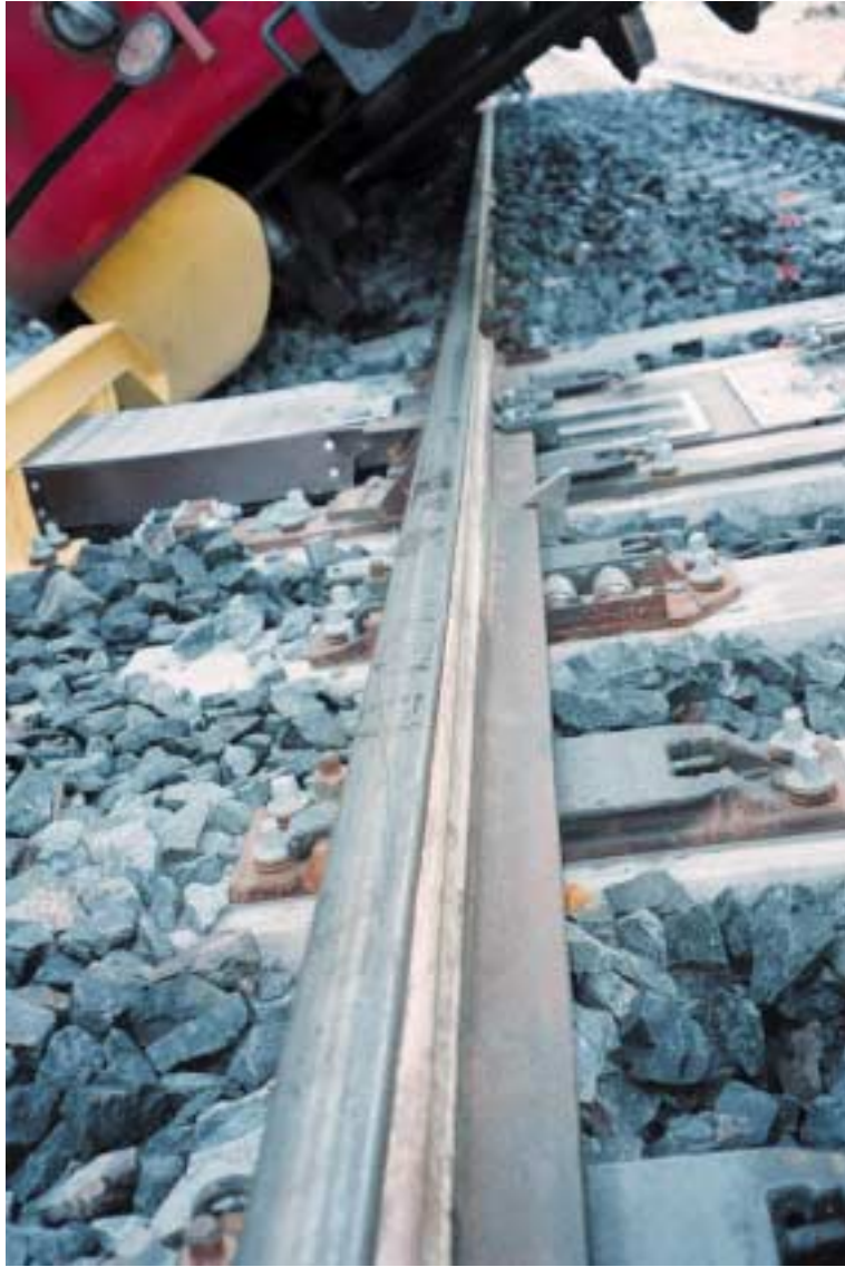
Kuva 5. Ttv:n suistuminen Saunakalliassa 27.8.1997. Vasemmanpuoleiset pyörät olivat nousseet vaihteen kielen ja kiskon päälle ja suistuneet siitä vasemmalle puolelle kiskoa. Huomaa kielen lukitsemiseen käytetty lukituslaite ja riippulukko.
