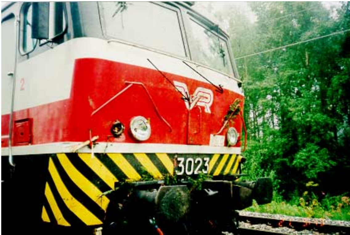
Kuva 4. Veturi kärsi onnettomuudessa pieniä vaurioita. Puun jättämä jälki näkyy oikealta alhaalta ajovalon kohdalta viistosti ylös vasemman ikkunan vasenta alakulmaa kohden. Junassa olleista seitsemästä vaunusta kolmessa oli havaittavissa vähäisiä raapautumajälkiä.
