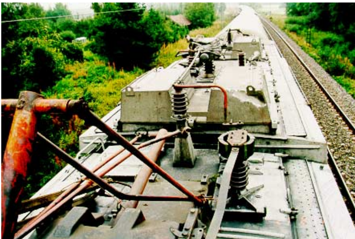
Kuva 5. Veturin pahimmat vauriot olivat katolla. Takimmainen virroitin repesi kokonaan irti ja kaikki kattorakenteet vaurioituivat.
