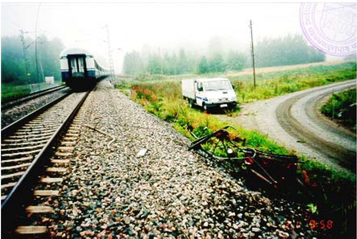
Kuva 3. Veturin katolla ollut takimmainen virroitin putosi kokonaan siihen takertuneen kääntöorren kanssa ennen junan pysähtymistä. Samaan paikkaan on myös pudonnut veturin oikeanpuoleinen peili.
