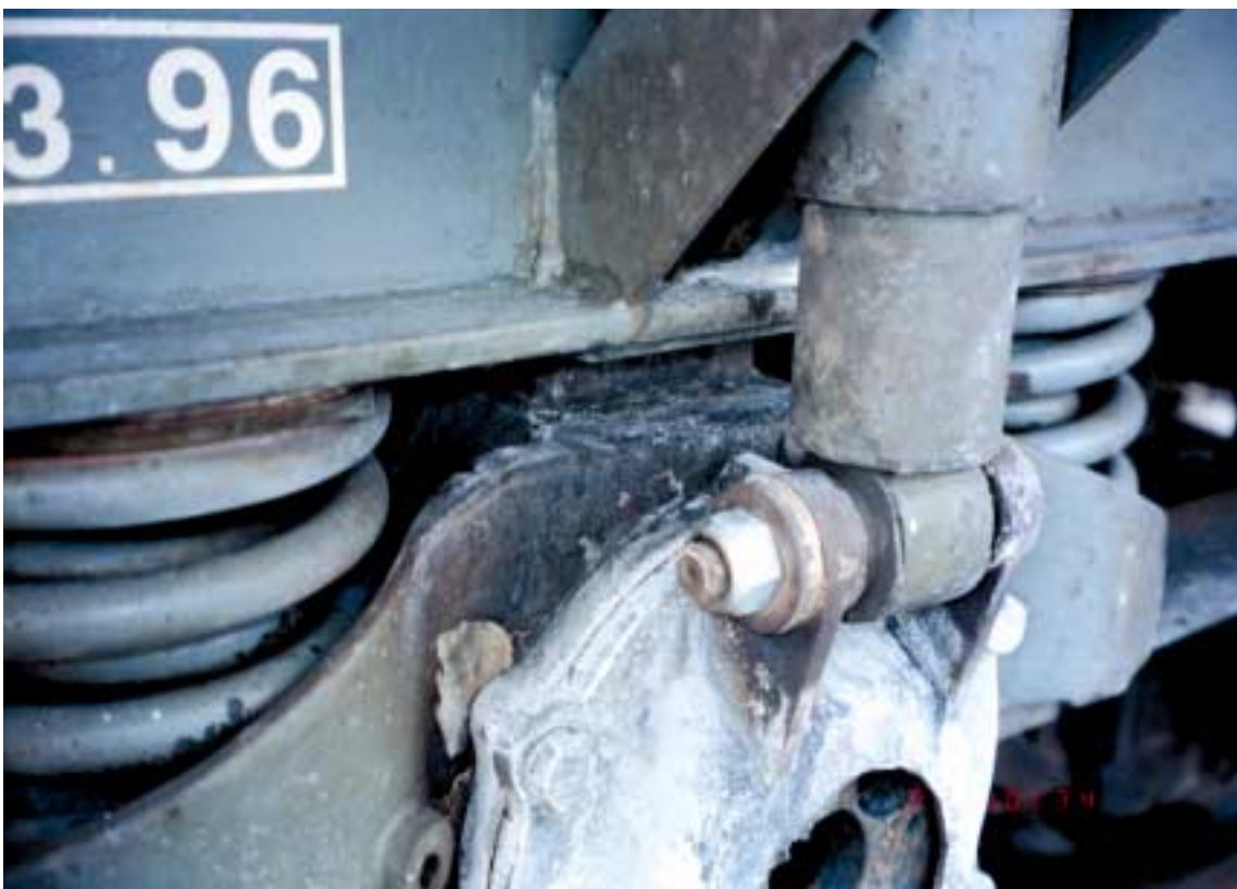
Kuva 4. Pikajunan vaunun laakerin ylikuumentumisesta aiheutunut vaaratilanne Hämeenlinnassa 23.6.1997. Tuli on kuumentanut myös telin runkoa.
