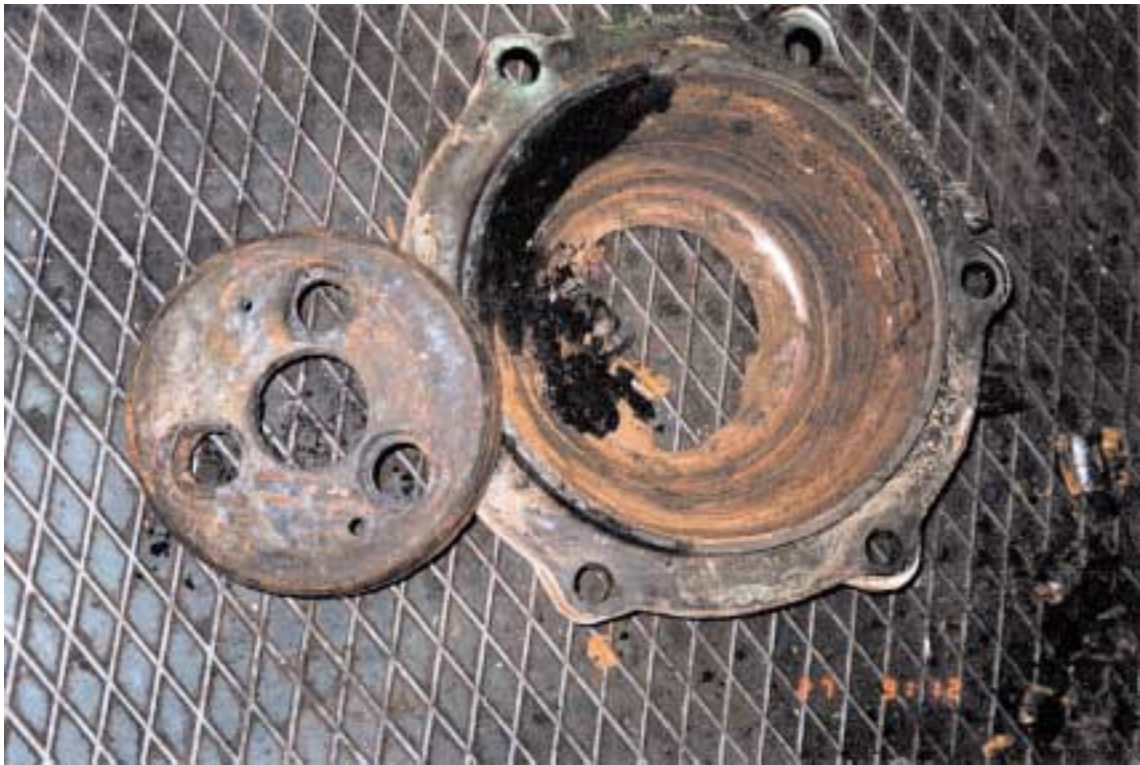
Kuva 7. Pikajunan vaunun laakerin ylikuumentumisesta aiheutunut vaaratilanne Hämeenlinnassa 23.6.1997. Vaurioituneen laakerin kansi sisältä sekä päätylaatta.
