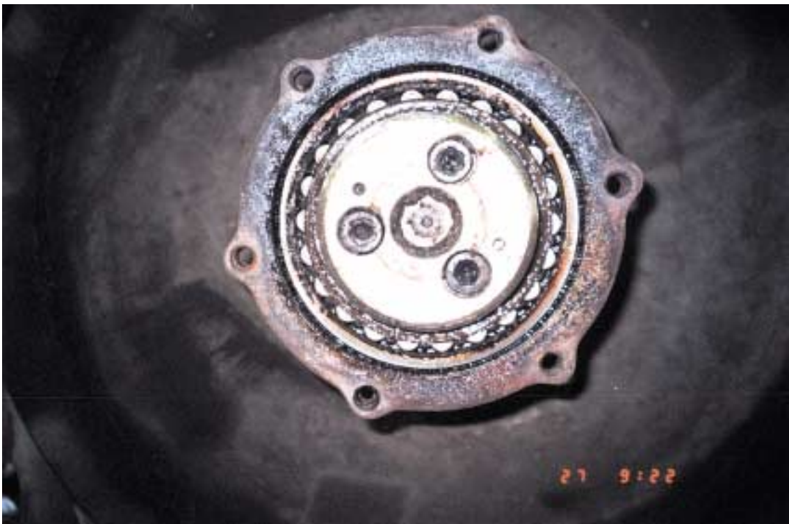
Kuva 6. Pikajunan vaunun laakerin ylikuumentumisesta aiheutunut vaaratilanne Hämeenlinnassa 23.6.1997. Ehjä laakeri kansi avattuna.
