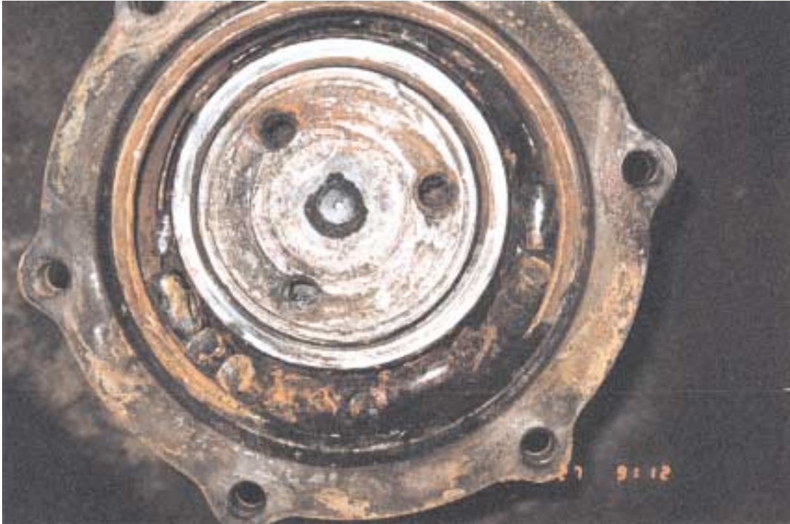
Kuva 5. Pikajunan vaunun laakerin ylikuumentumisesta aiheutunut vaaratilanne Hämeenlinnassa 23.6.1997. Vaurioitunut laakeri kansi avattuna.
