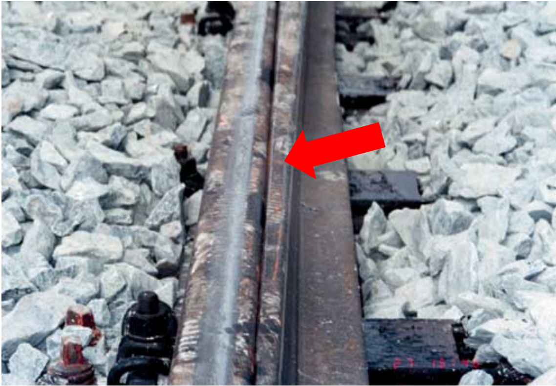
Kuva 2. Ensimmäinen pyörän jälki 2 metriä vaihteen V70 vasemmanpuoleisenkielen kärjestä.
