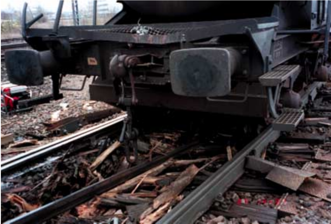
Kuva 10. Kaatuneen vaunun takana tulleen vaunun etuteli tippui levinneen raiteen kiskojen väliin.
