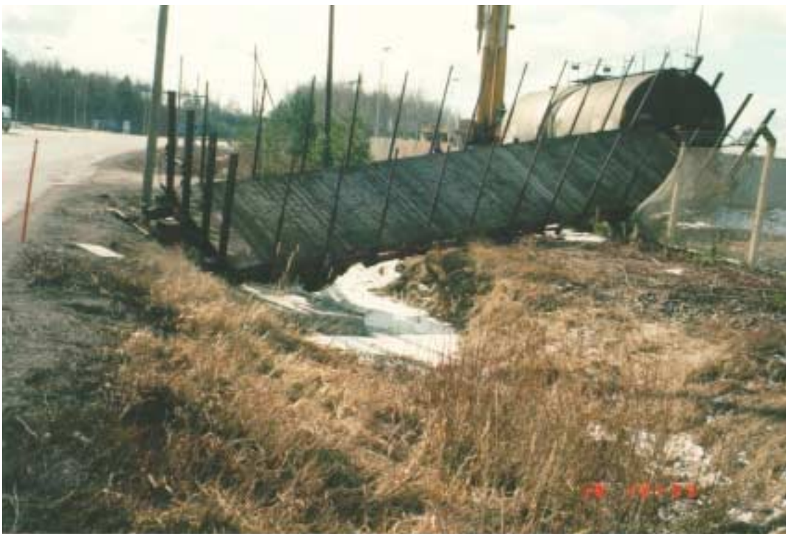
Kuva 3. Maantien penkkaan suistunut Hkba-välivaunu.
