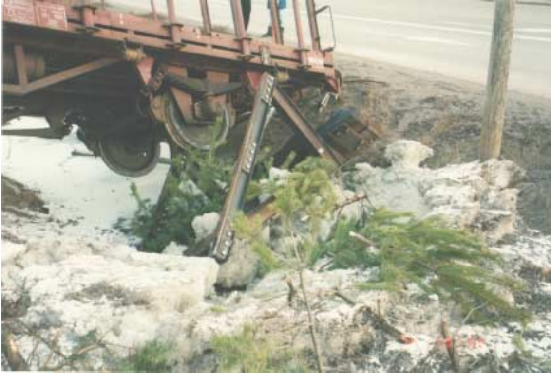
Kuva 4. Irttonut raidepuskin Hkba-välivaunun alla.
