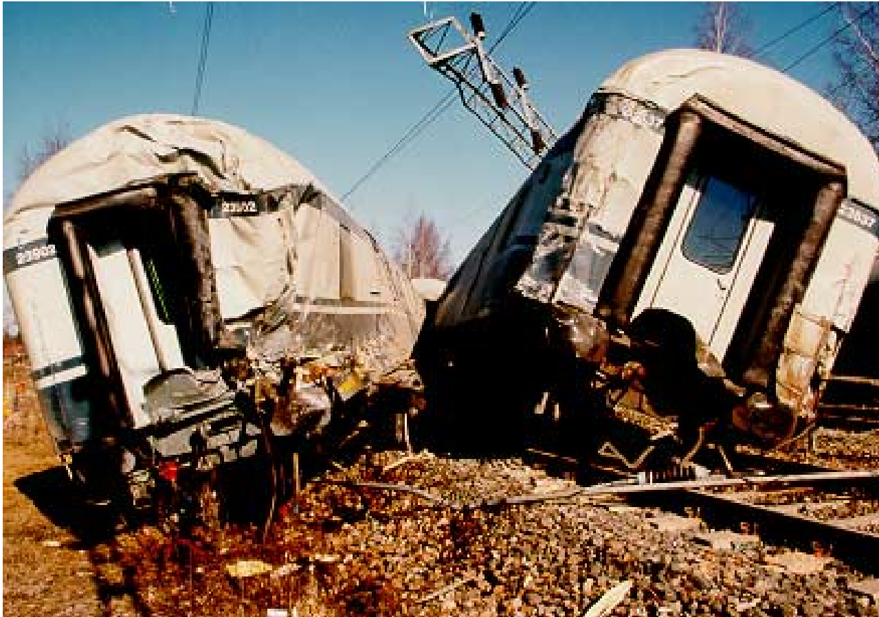
Kuva 6. Viuhkamuodostelmassa olevat junan kolmantena vaununa ollut ravintolavaunu (oik.) ja neljäntenä ollut konduk- töörivaunu.
