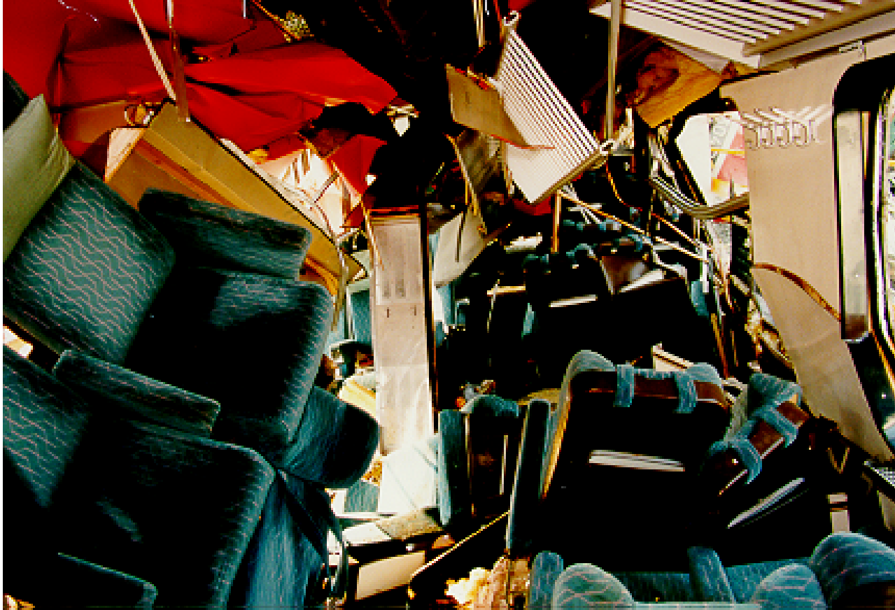
Kuva 9. Edellisessä kuvassa olevan päivävaunun sisäpuolen vaurioita onnettomuuspaikalla. Rikkoutuneesta ikkunasta näkyy veturi. Vaunun vastakkaiseen puoleen samaan kohtaan tulleet vauriot aiheutuivat ravintolavaunun törmäyksestä. Tässä vaunussa matkustaneiden vammat olivat lieviä.
