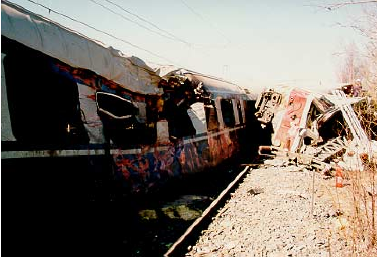
Kuva 8. Veturin jälkeen ensimmäisenä olleen päivävaunun ulkoiset vauriot onnettomuuspaikalla. Vaunun kyljessä näkyy veturin takapäin tekemä törmäysaukko vaunun ohittaessa kaatumassa olleen veturin. Suurin osa matkustajista poistui vaunuun repeytyneistä aukoista.
