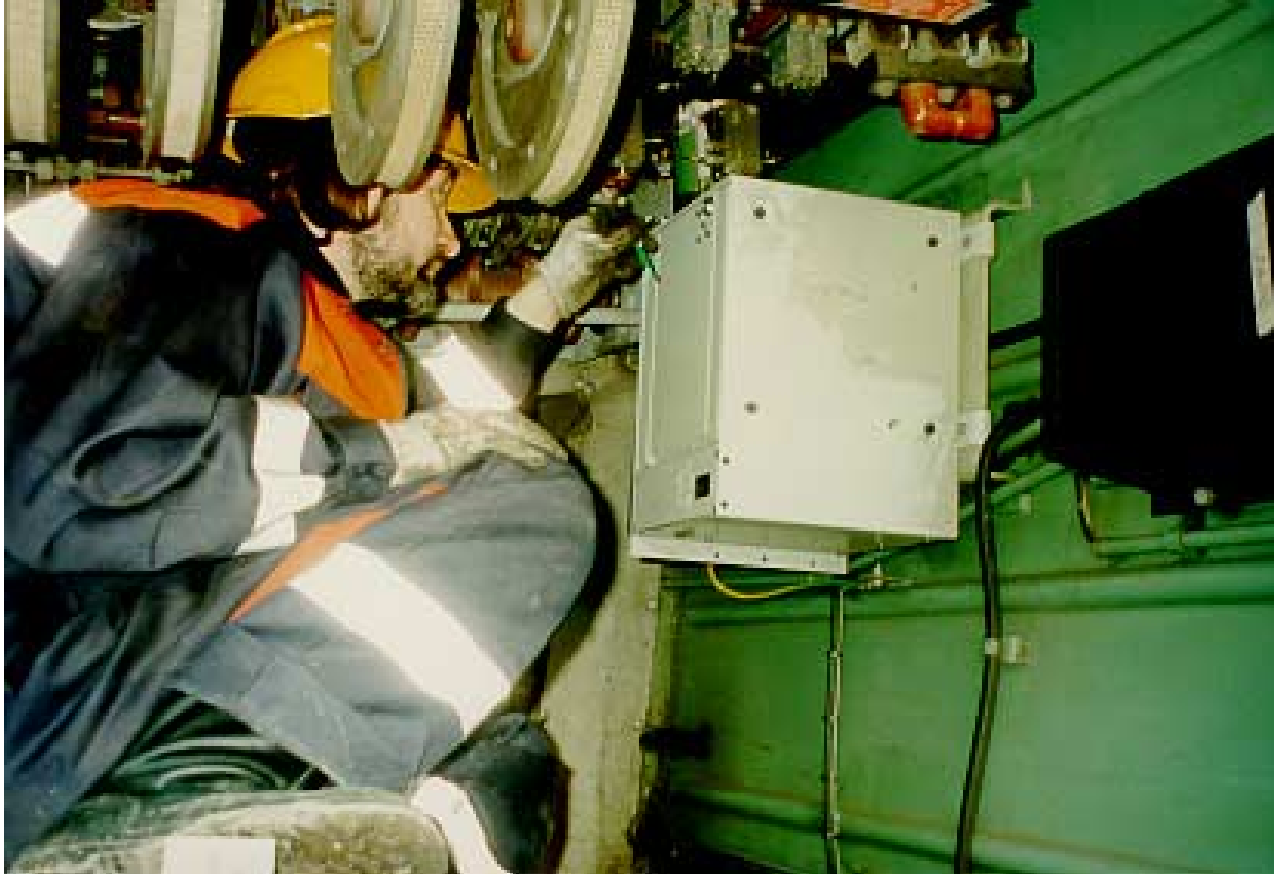
Kuva 13. Rekisteröintilaitteen muistimodulin (ns. musta laatikko) talteenotto. Onnettomuusveturissa musta laatikko oli sijoitettu kassakaappiin, joka oli moottoritilan takaseinässä. Muistimodulin sijoitus oli onnistunut, koska laitteisto ei onnettomuuden rajuudesta huolimatta vaurioitunut lainkaan.
