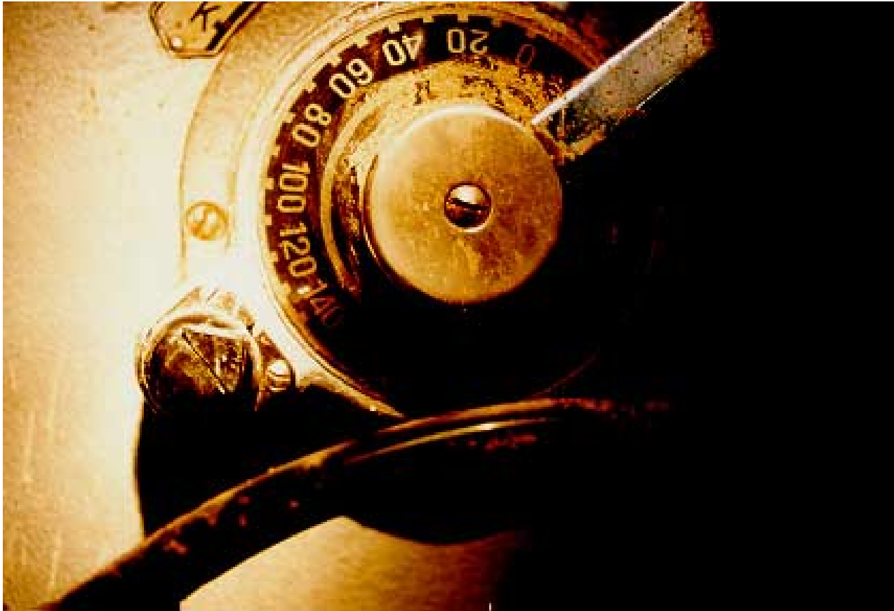
Kuva 15. Lähikuva onnettomuusveturin ohjauspöydän nopeudenasettimen asteikosta. Nopeudenasettimeen oli (vakionopeudensäädin) valittu nopeudeksi 130-135 km/h.
