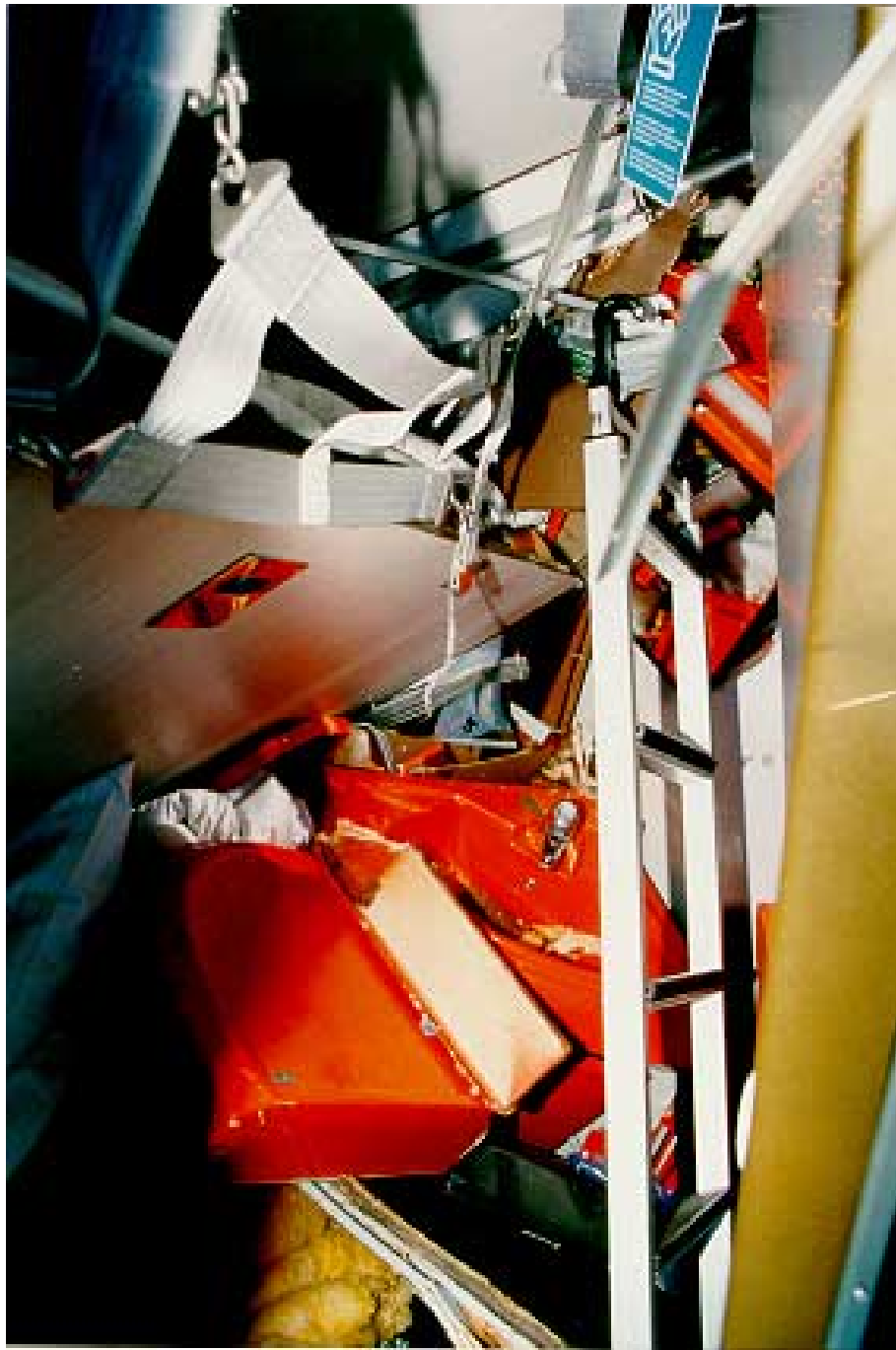
Kuva 11. Viidentenä olleen makuuvaunun hyttiosaston vaurioita. Vaikka vaunu taittui, lattia rikkoutui ja nousi hyttiosastoon, selvisivät matkustajat lievin vammoin.
