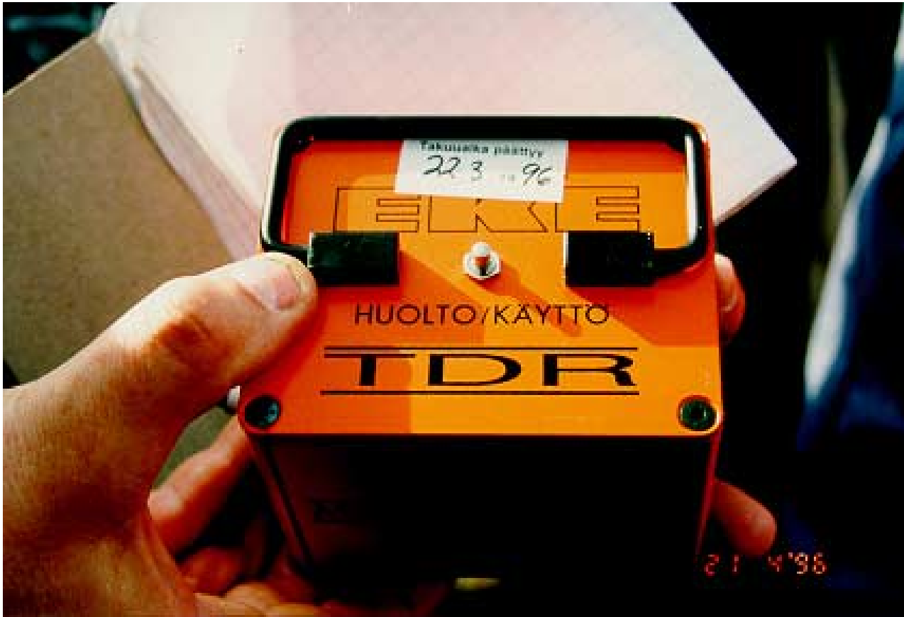
Kuva 12. Onnettomuusjunasta talteen otettu oranssin värinen muistimoduli. Viimeisen kahden kuukauden tapahtumat tallentuvat moduliin.
