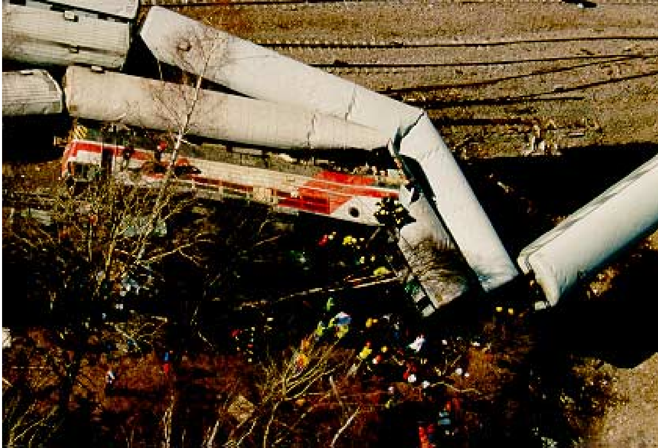
Kuva 5. Kaatuneen veturin etupää murskasi veturiin poikittain törmänneen päivävaunun. Makuuvaunu taittui murskaantuneen päivävaunun päälle junan loppupään työntämänä.
