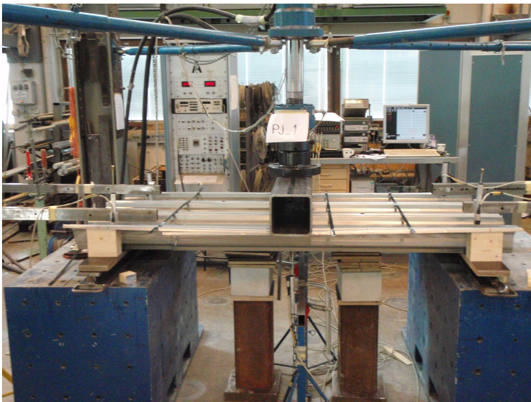
Kuva 3.9 Testimenetelmän 2 koejärjestelystä (pistekuorma keskellä, jatkettu pelti).
