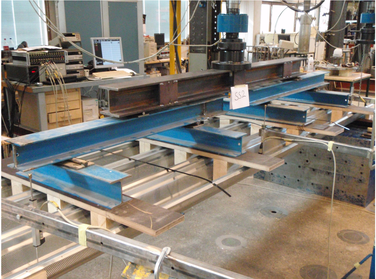
Kuva 3.4 testimenetelmän 1 koejärjestelystä (tasainen kuormitus, leveä laippa tukea vasten)
