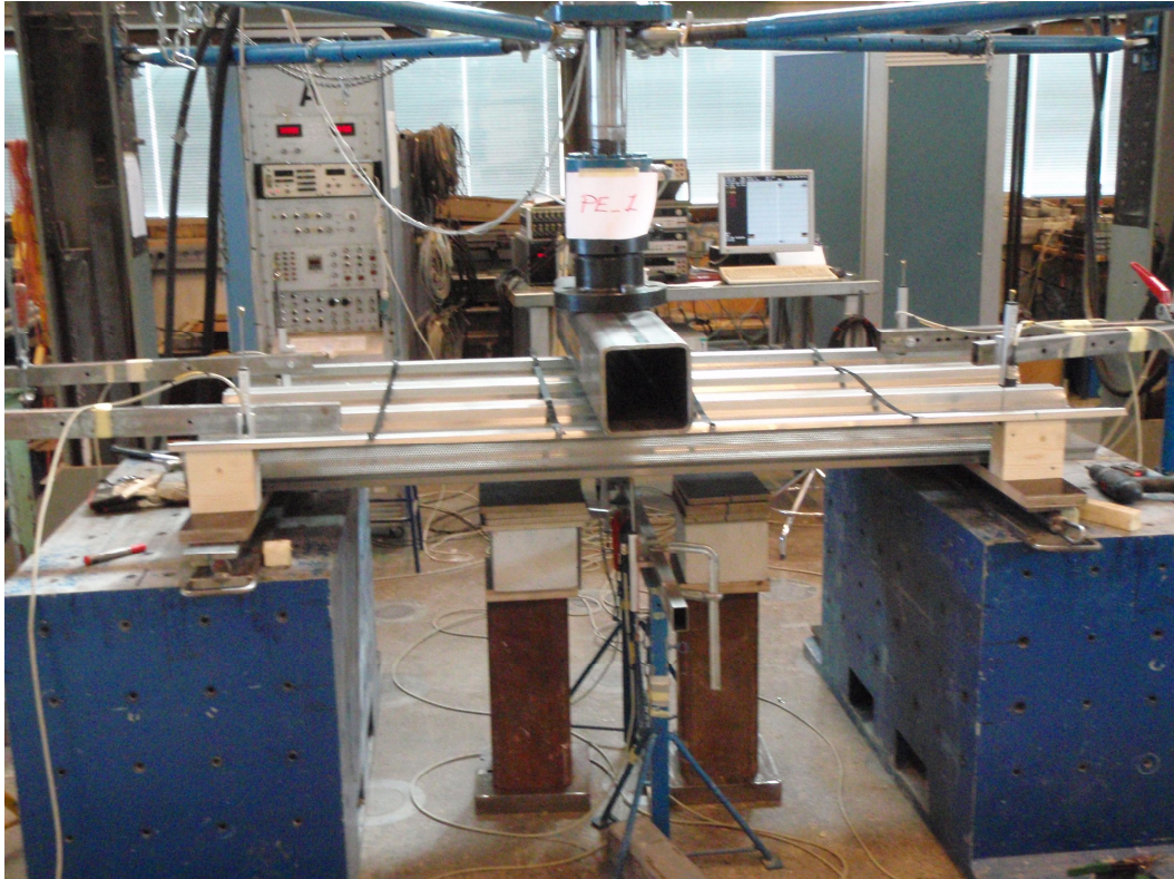
Kuva 3.8 Testimenetelmän 2 koejärjestelystä (pistekuorma keskellä, jatkuva pelti).
