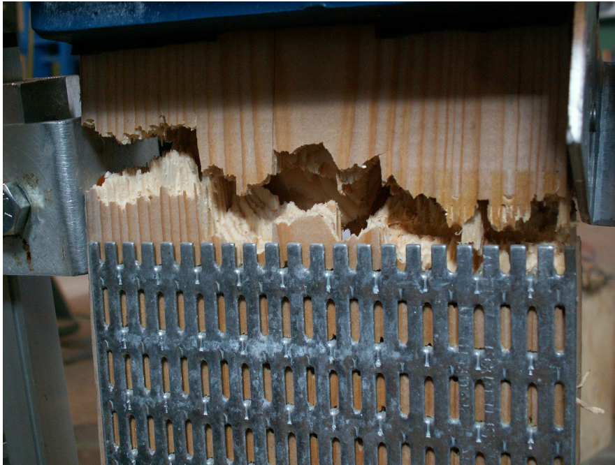
Kuva 4.5 Kokeen L5 paarteen vetomurto naulalevyn yläpuolelta kuormalla F_{max} = 109,8 \text{ kN} .
