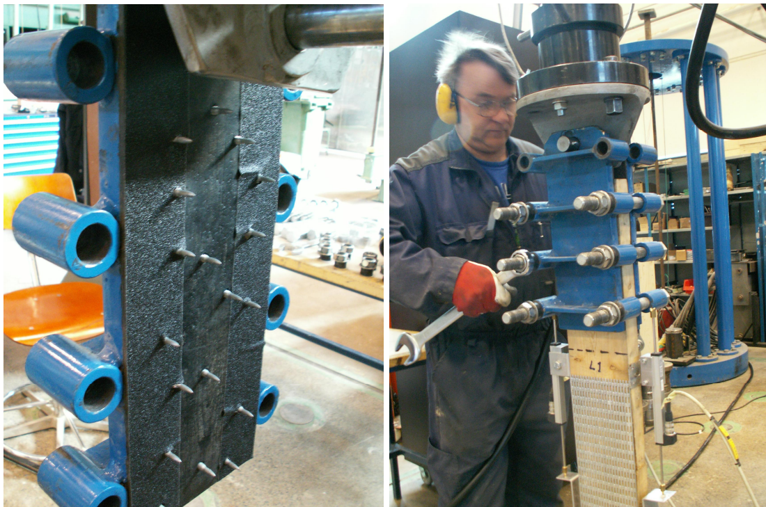
Kuva 3.1 Vetolaitteen kiinnitysleukojen karhennus ja tartuntapiikit, sekä leukojen kiinnitys koekappaleeseen 8 M24 pultin avulla.
