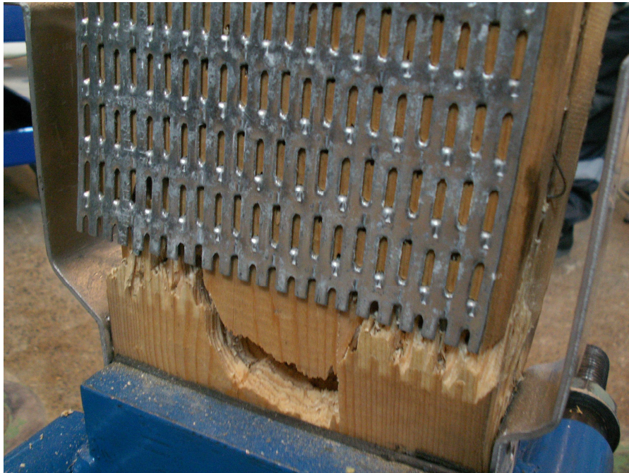
Kuva 4.2 Kokeen L1 liitoksen alapuolisen paarteen vetomurto naulalevyliitoksen alapuolelta kuormalla F_{max} = 108,1 kN.
