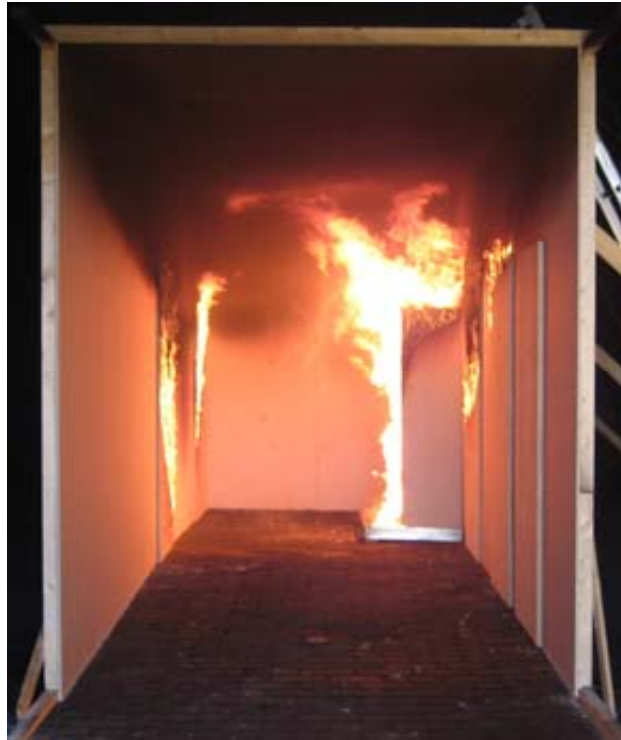
Kuva 16. Palon kehittyminen 5 minuutin kuluttua sytytyksestä.
