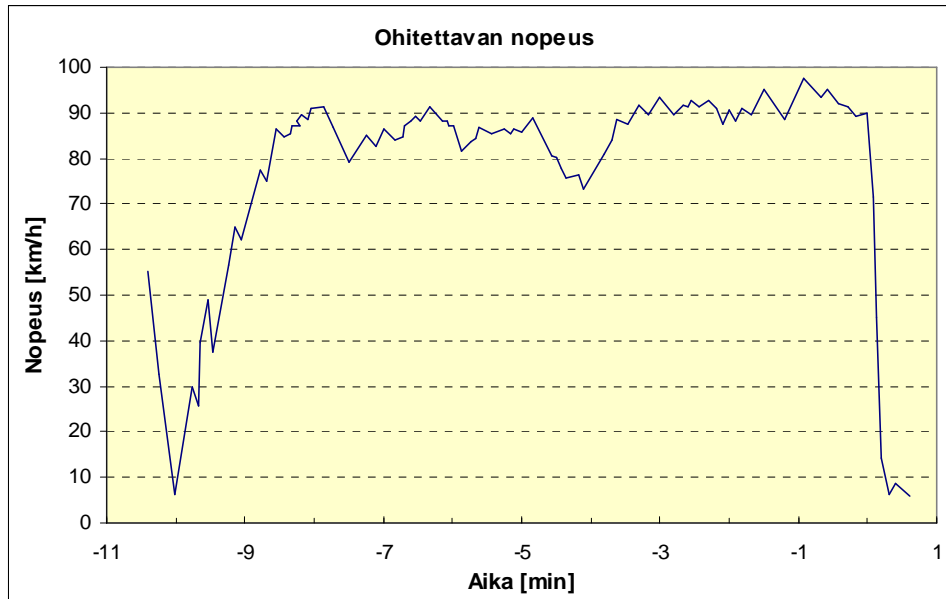
Kuva 6. Ohitettavana olleen puoliperävaunullisen kuorma-auton nopeus ajan funktiona (viimeiset 11 minuuttia ennen onnettomuuspaikkaa).
