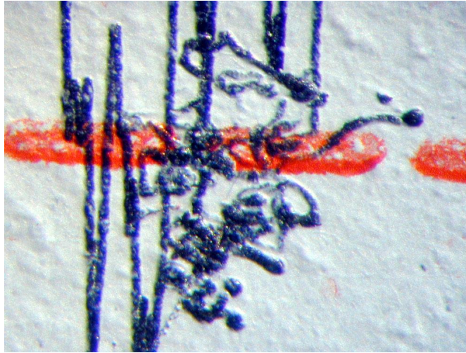
Kuva 11. Lähikuva ohittamassa olleen linja-auton ajopiirturikiekon nopeuspiirrosta törmäyshetkellä.
