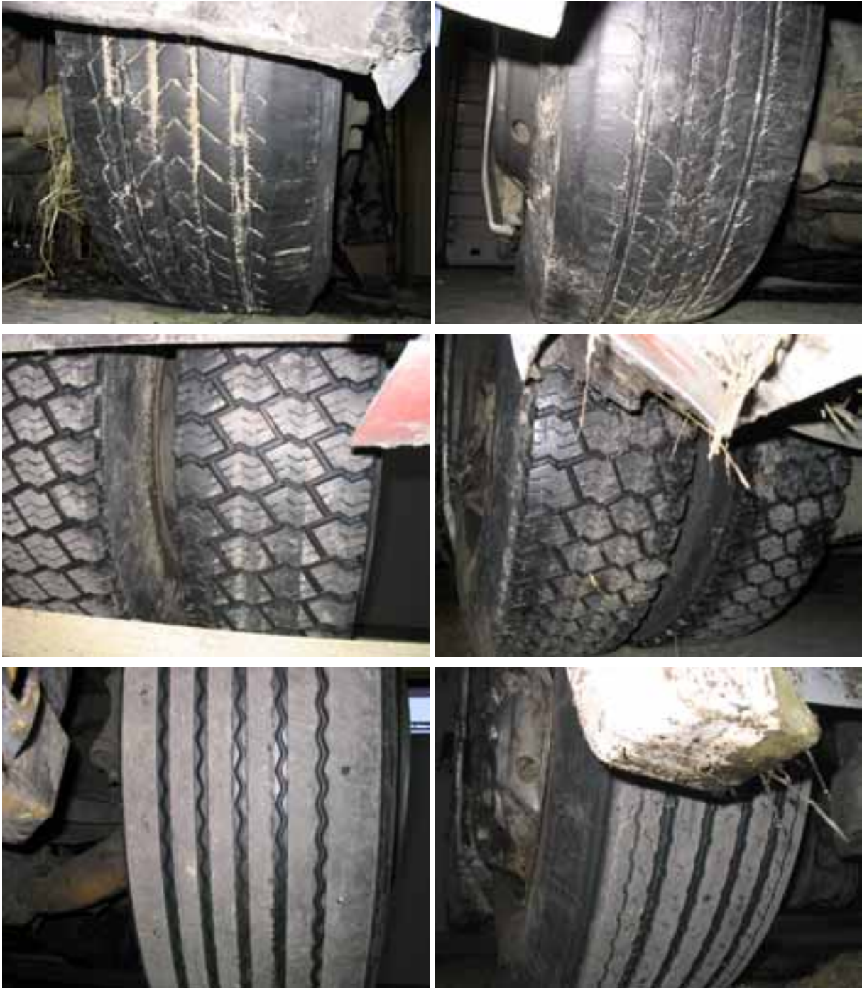
Kuva 7. Ylimpänä vasemmalla etuakselin vasen rengas ja oikealla oikea eturengas. Toisella rivillä on vastaavalla tavalla vetävän akselin ja alimpana takimmaisen akselin renkaat. Eturenkaat olivat kuluneimmat joskin selvästi lain vaatiman 1,6 mm täyttävät.
