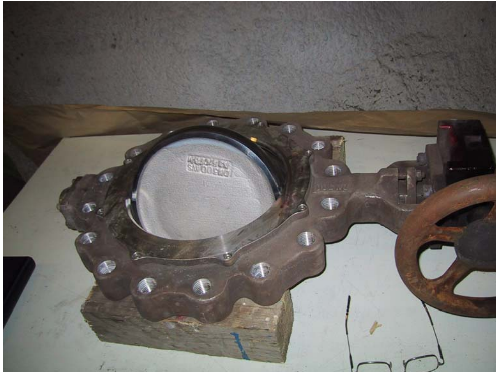
Kuva 1 Palaneen venttiilin kanssa samanlainen perhosventtiili. Tätä venttiiliyksilöä ei käytetty kokeissa.
