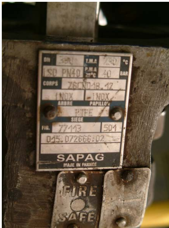
Kuva 2 Kokeessa käytetyn venttiilin tunnistekilpi.
