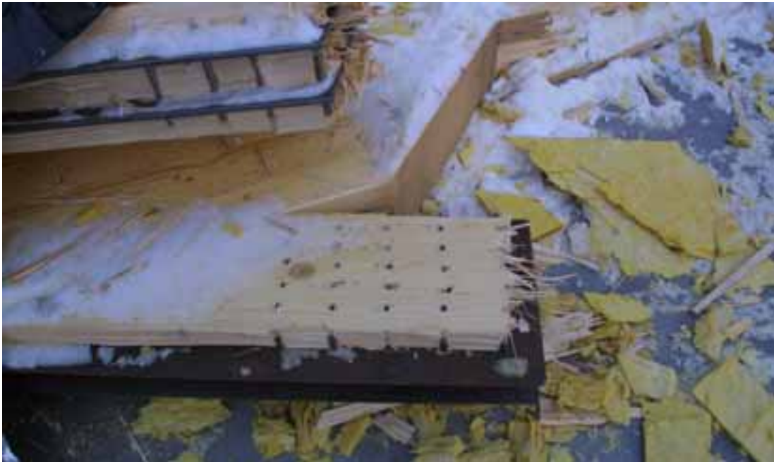
Kuva 17. Tappivaarnaliitos, joka on murtunut lohkeamalla puuosasta uloimman tappirivin kohdalta. (Kuva: Poliisin arkisto)
