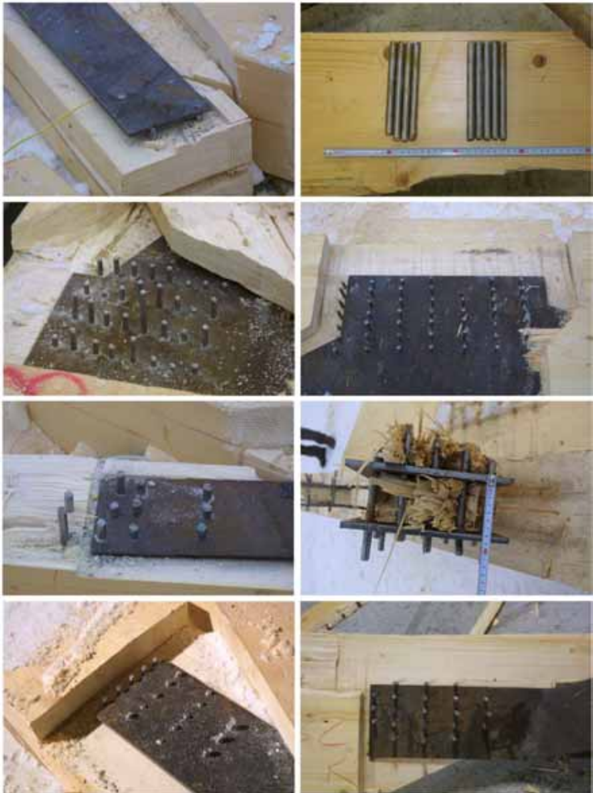
Kuva 11. Kuvakooste joistakin tutkintalautakunnan avaamista tappivaarnaliitoksista, joissa oli puutteita. (Kuvat: Poliisin arkisto)
