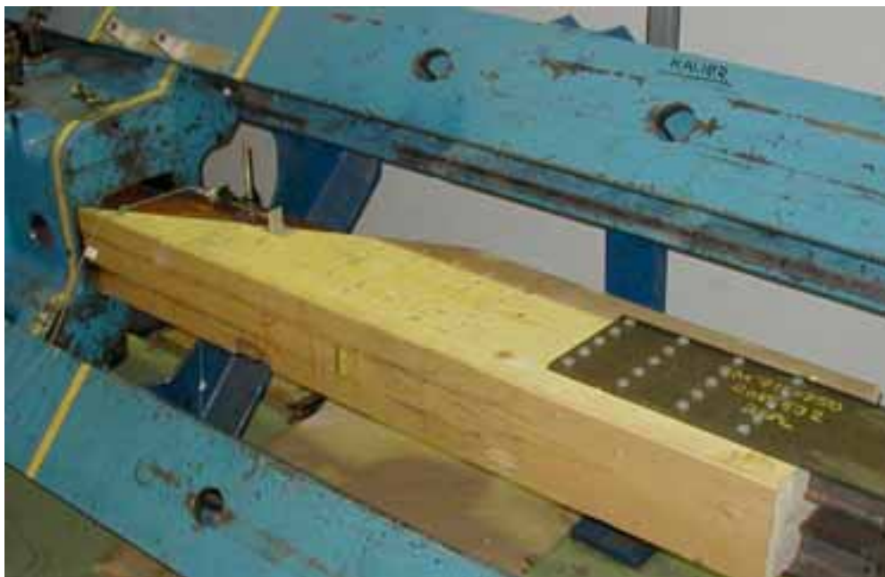
Kuva L7. Vetokokeiden kuormitusjärjestely. Tutkittava liitos on kuvassa vasemmalla ja oikealla näkyvä liitos on kokeen vaatima apuliitos.
