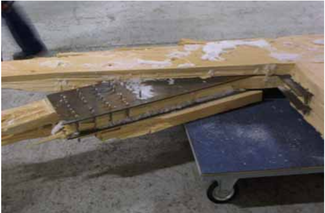
Kuva 8. Rikkoutunut tappivaarnaliitos. (Kuva: Poliisin arkisto)
