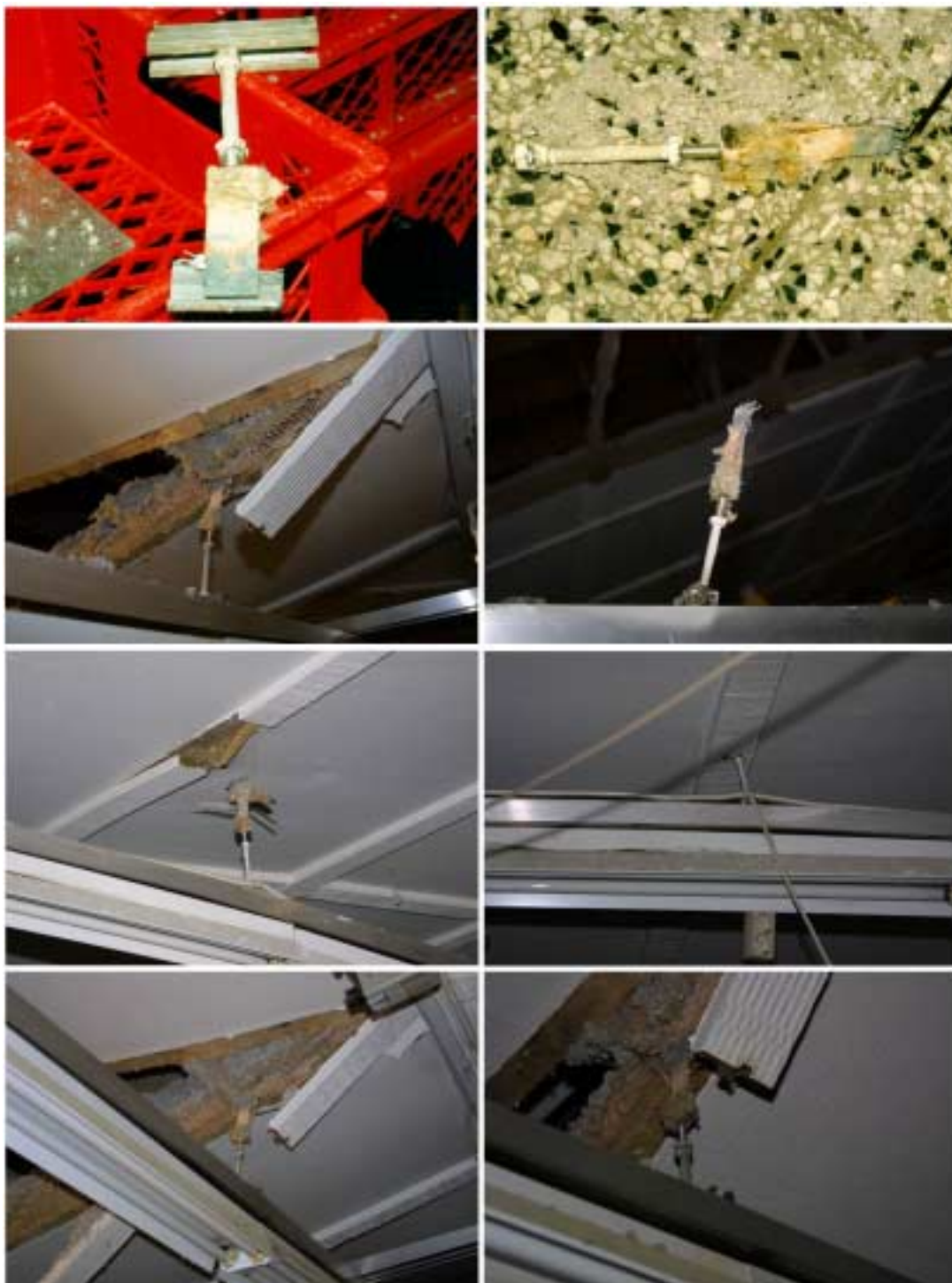
Kuva 8. Kuvia sisäkaton kannatuslistassa riippuneista ripustusosista. Ylikuormitetut ripustusosat irtosivat kannatuslistoista eri tavoin. Osa ripustusosista rikkoutui, joissain kohdissa kannatuslista vääntyi ja toisaalla osa irtosi kannatuslistasta säilyen lähes ehjänä.
