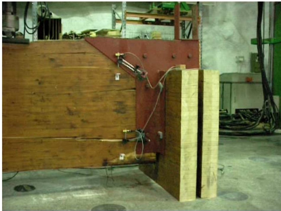
Kuva 11. Liitos kuormituskokeen lopussa. Alimman ruuvin kohdalla oleva halkeama on alkanut kasvaa samalla tavalla kuin kattovaurion tapahtuessa.
