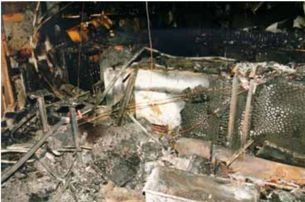
Kuva 24. Keskellä kuvaa palon syttymislähde, juomien säilytykseen tarkoitettu valkoinen kylmäallas.
