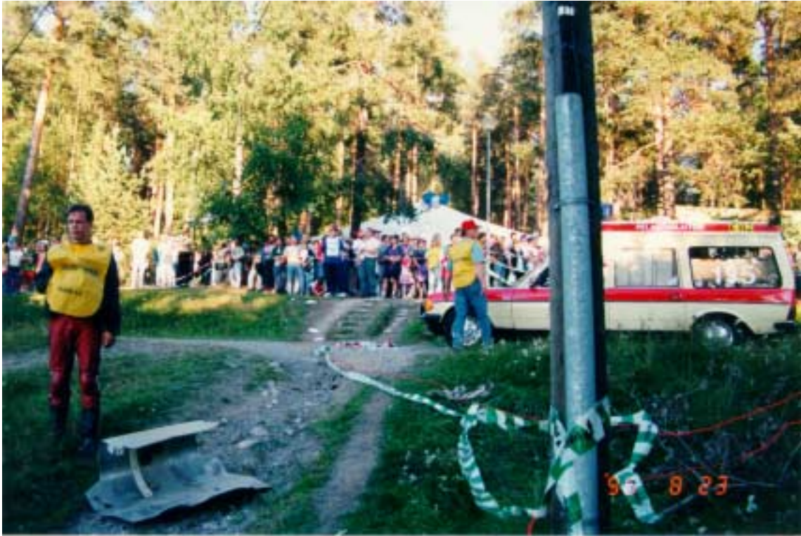
Kuva 8. Onnettomuusauton moottorin suojana ollut panssari irtosi etukiinnikkeistään ja rullautui auton alle nostaen auton uudelleen irti maasta.
