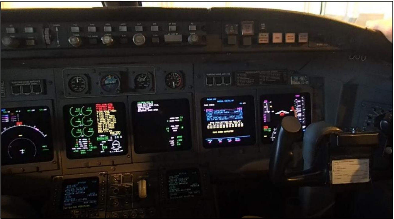
Kuva 8. Toisessa vaaratilanteessa aktiiviselle kiitotielle rullanneen Bombardier CL-600-2B16:n mitaristoa. Kuvassa oleville näytöille on valittu seuraavat toiminnot vasemmalta oikealle: navigointi, kahdella seuraavalla järjestelmätietoja (esimerkiksi moottoriarvoja), seuraavassa tarkistuslista, viimeisenä lennonvalvontamittarit. Kuvan ulkopuolella vasemmalla on vielä yksi näyttö. (Kuva: OTKES)
