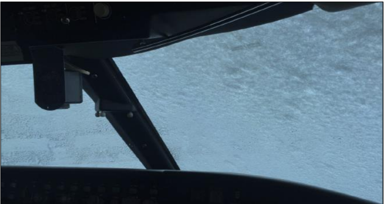
Kuva 3. Ohjaamomiehistön tapahtumapäivänä 24.1. ottama valokuva jäätyneestä tuulilasista ennen sen lämmittämistä. (Kuva: Jetflite)
